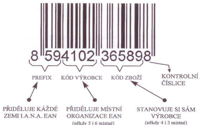
Obr. 13: Struktura čárového kódu [2]
