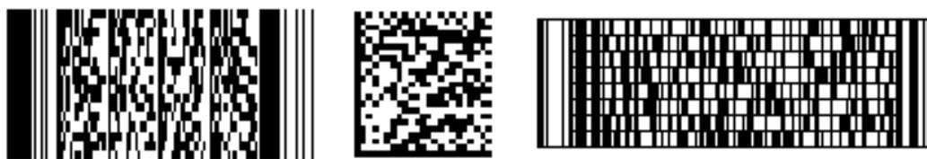
Obr. 19: Příklad dvourozměrných čárových kódů [8]
