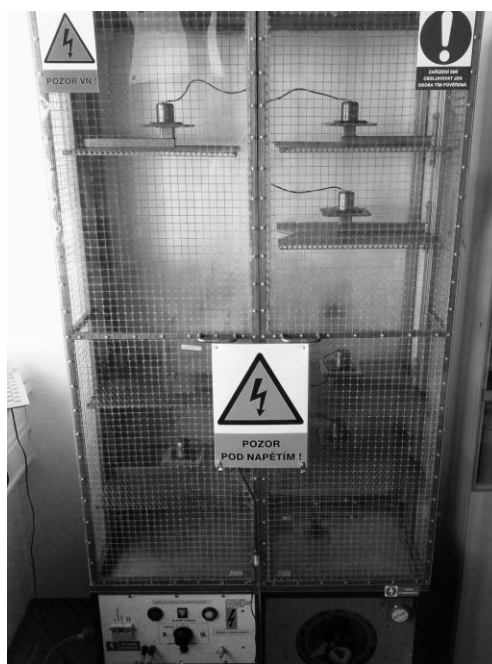
Obrázek 3.1 - Zařízení pro řízenou degradaci sinusovým napětím
