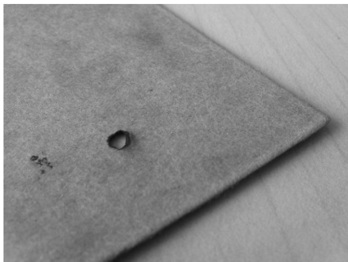
Obrázek 2- Průraz testovaného vzorku
