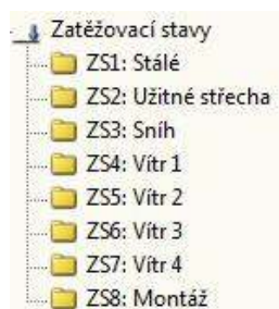
Obr. č.27-Přehled zatěžovacích stavů
