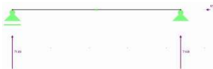
Obr. č.14-Reakce od stropní konstrukce nad 2. NP
