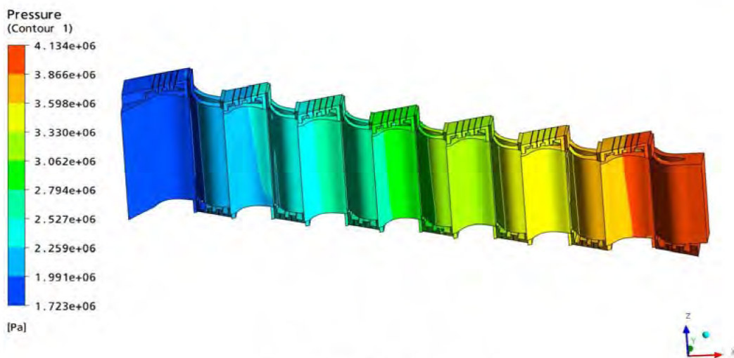
Obr. 2.6 Kontury celkového tlaku ve výpočtové oblasti turbínového stupně
