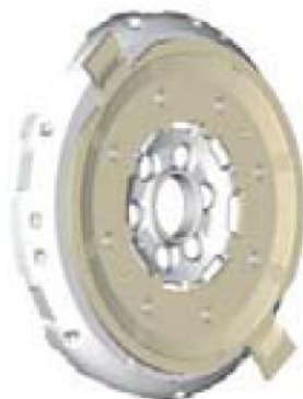
obr. 43: sekundární část setrvačnicku s pevnou přírubou [32]
