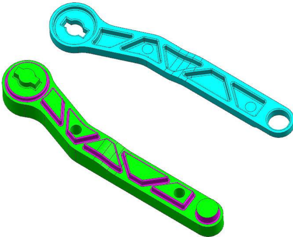
Obr. 17 Úkosovaná tvarová vložka (barevně vyznačené plochy)
