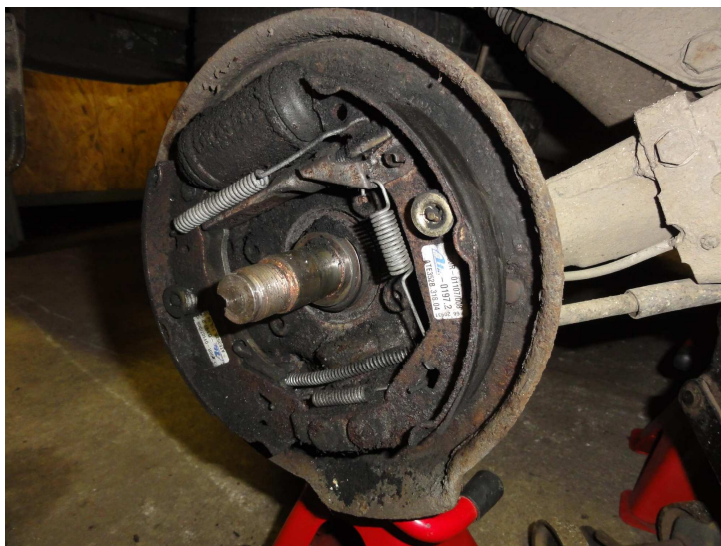
Obr.3: Netěsnící kolový válec, nadměrně opotřebené brzdové čelisti [15]
