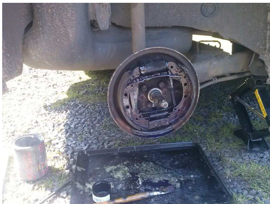
Obr.2: Netěsnící kolový válec, poškozená vratná pružina
