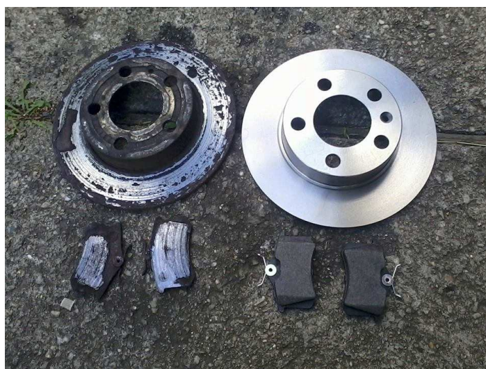
Obr.17: Nadměrně zkorodovaný a opotřebený kotouč s destičkami - porovnání s novým
