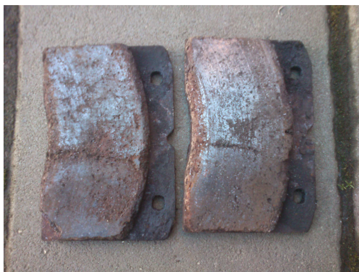
Obr.4: Opotřebené brzdové destičky s prasklým obložením
