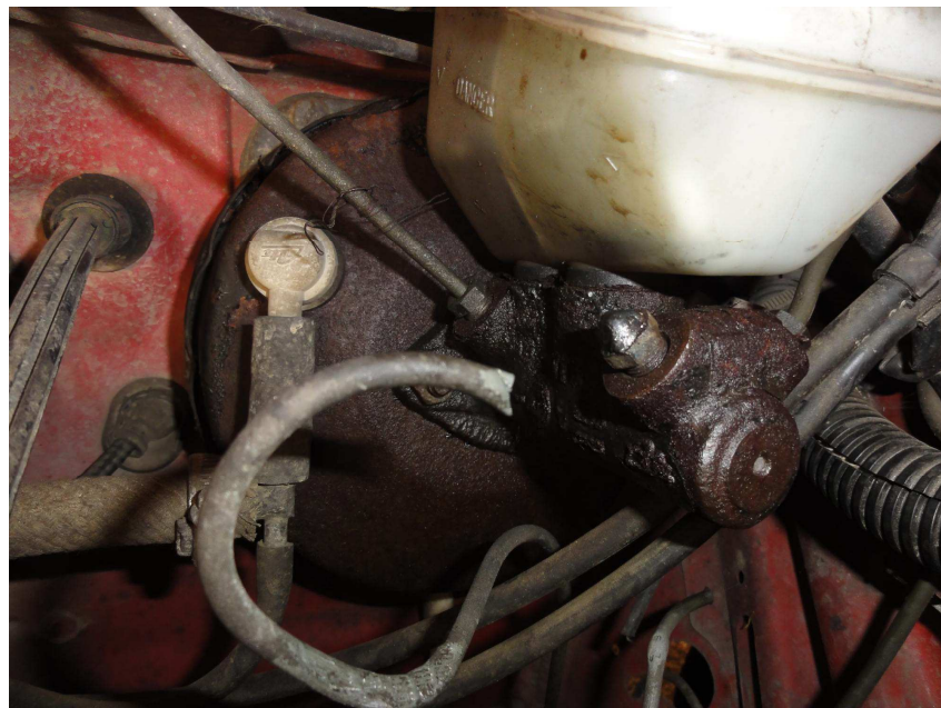
Obr.1: Velice neodborná oprava - zaslepení netěsnícího vedení kapaliny [15]
