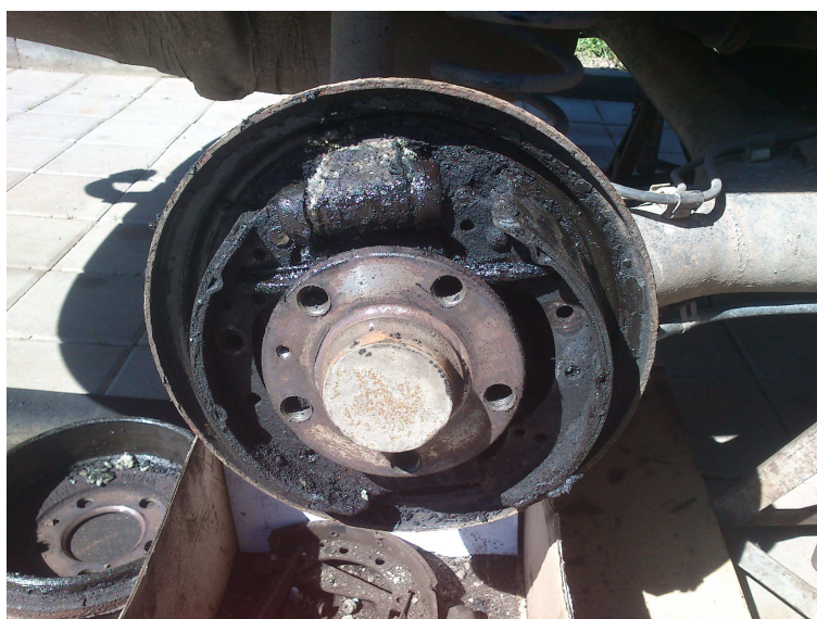
Obr. 3.13: Netěsnící kolový válec (další fotografie v příloze č.1)
