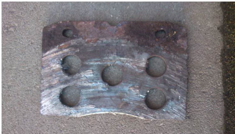
Obr.6: Brzdová destička s chybějícím obložím, kdy již brzdila kovovou nosnou částí
