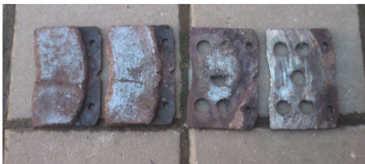
Obr. 3.11: Nadměrně opotřebované brzdové destičky (další fotografie v příloze č.1)
