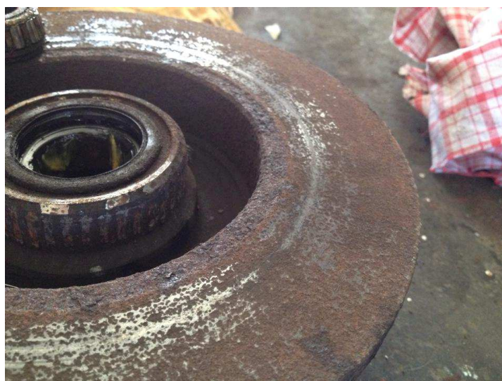
Obr.16: Další případ příliš zkorodovaného kotouče
