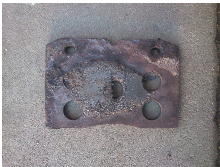
Obr.5: Brzdová destička s posledními pozůstatky obložení
