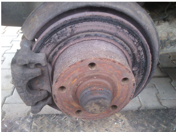
Obr.15: Koroze kotouče - špatná účinnost brzdy
