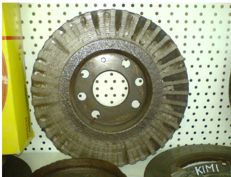
Obr.11: Vnitřně větraný kotouč, opotřebený až k žebrování [15]
