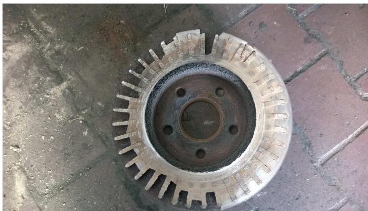
Obr. 3.12: Extrémně opotřebovaný kotouč [15] (další fotografie v příloze č.1)
