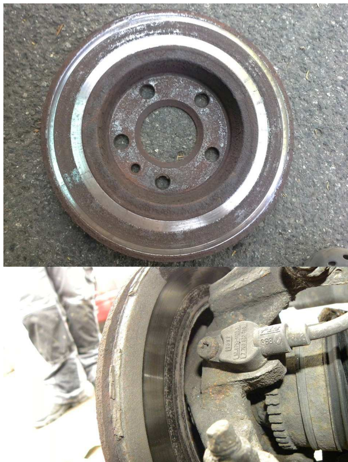
Obr.18 a 19: Zkorodované kotouče, kdy destička zabírala jen částečně [15]
