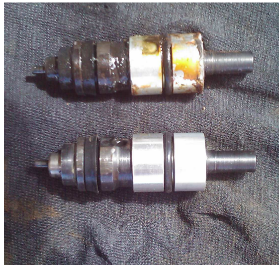
Obr. 3.14: Zkorodovaný pístek zátěžového regulátoru
