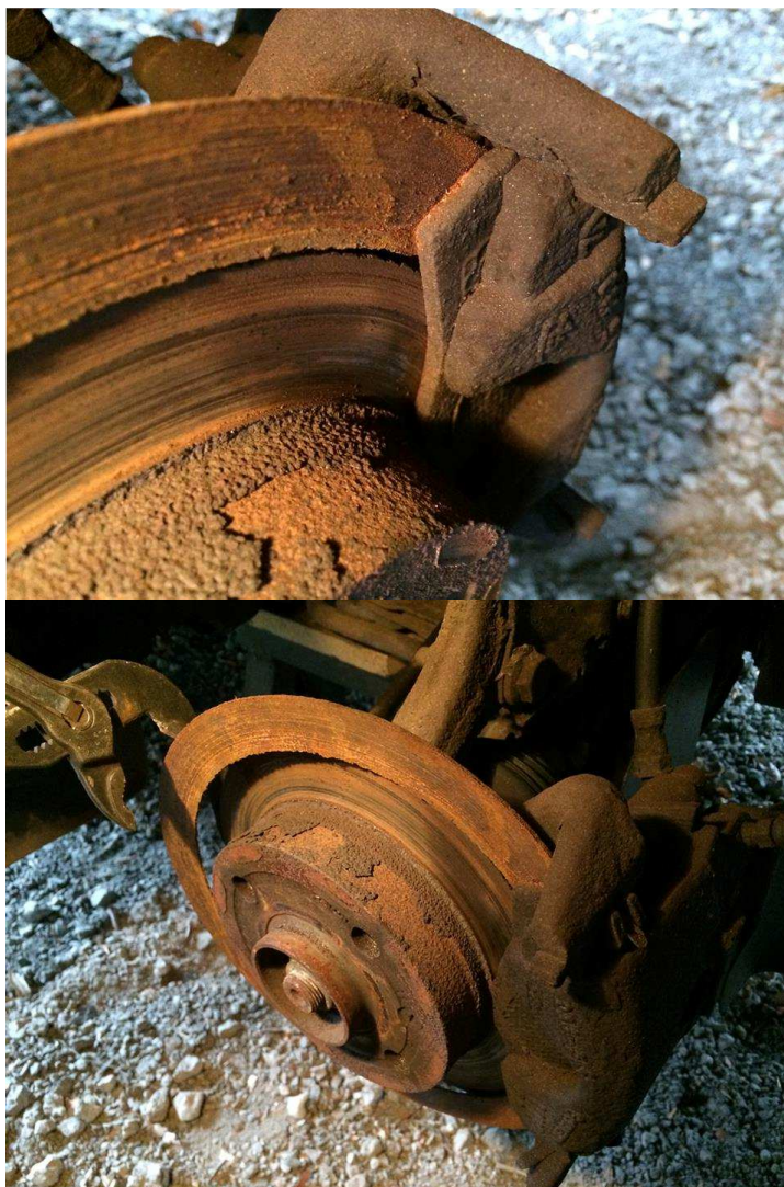
Obr.9 a 10: Extrémně opotřebený brzdový kotouč, kdy už došlo k odtržení jeho části [15]
