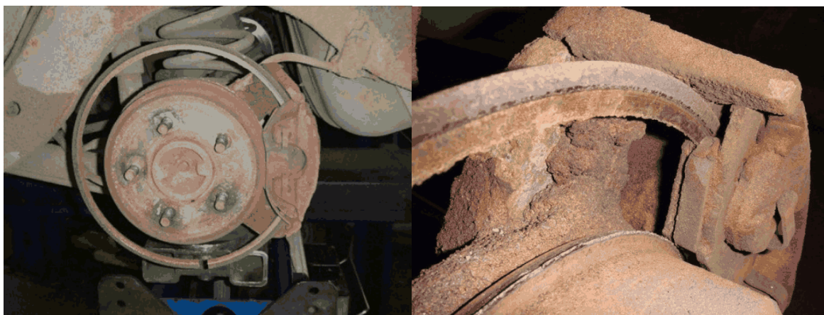
Obr.22 a 23: Extrémní opotřebení kotouče, kdy byl věnec zcela probrzděn [15]
