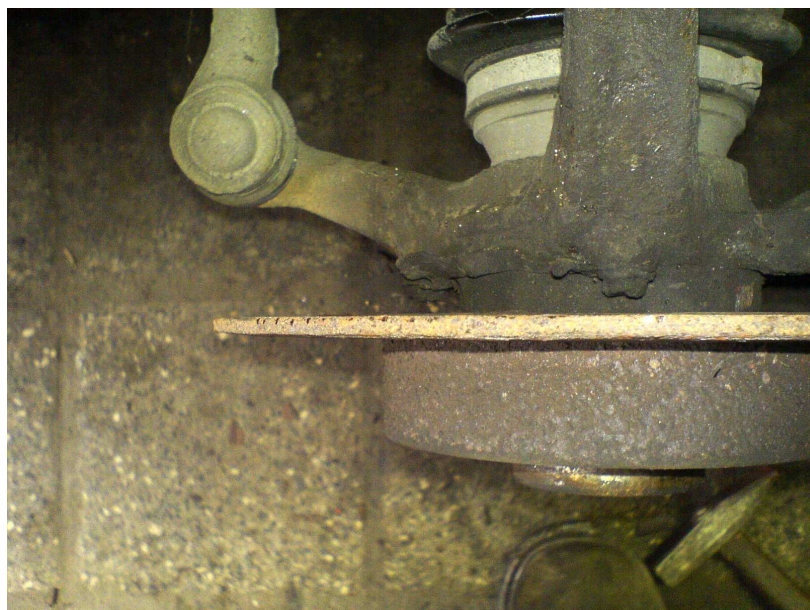
Obr.8: Nadměrně opotřebený brzdový kotouč
