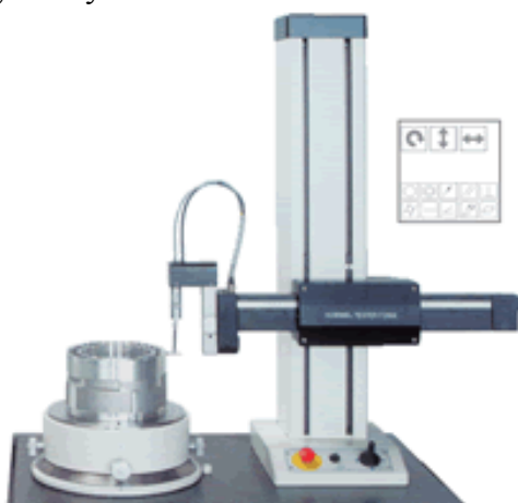
Obr. 79 Přístroj pro měření válcovitosti Hommel Tester Form 1004 spolu se znázorněním výsledků [19]
