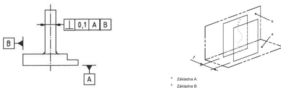
Obr. 33 Označení a vysvětlení geometrické tolerance kolmosti přímky k rovině [4]
