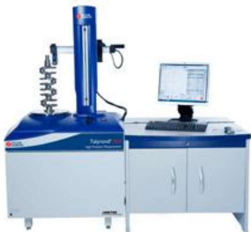
Obr. 76 Přístroj k měření kruhovitosti Talyrond 500 [18]
