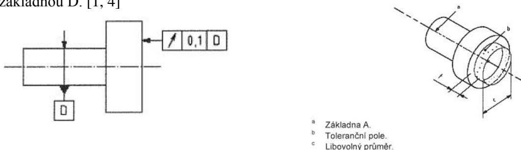
Obr. 49 Označení a vysvětlení geometrické tolerance kruhového házení čelního [4]
