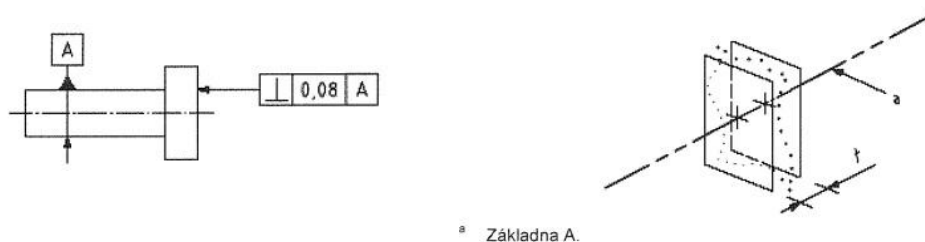
Obr. 34 Označení a vysvětlení geometrické tolerance kolmosti roviny k přímce [4]
