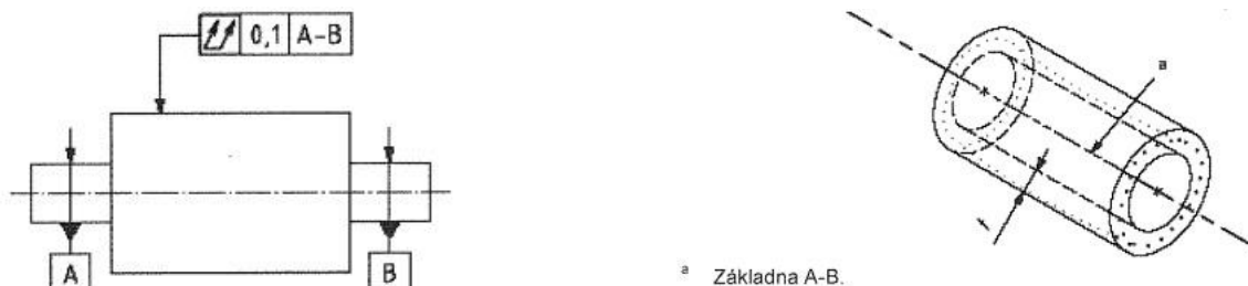
Obr. 51 Označení a vysvětlení geometrické tolerance celkového obvodového házení [4]
