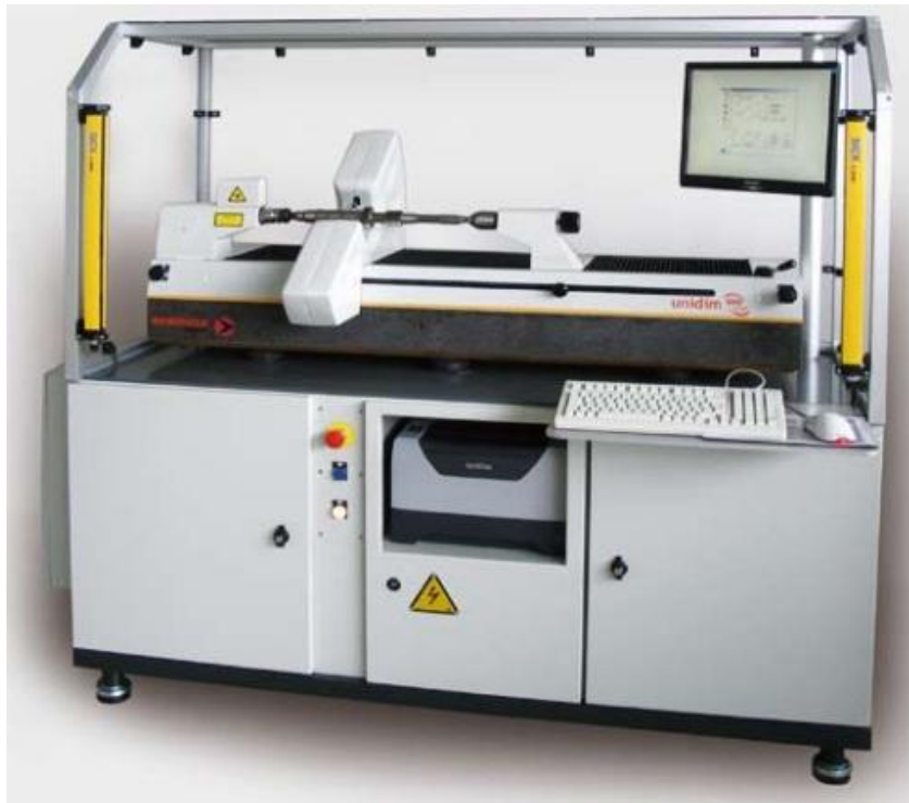
Obr. 93 Přístroj Unidim pro měření kruhového házení čelního [23]
