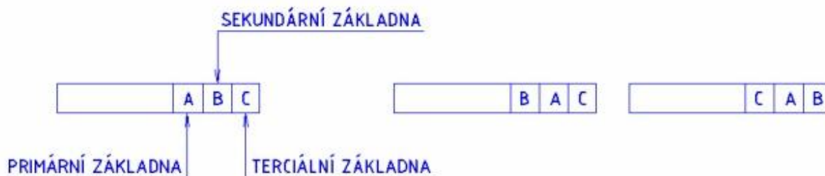
Obr. 10 Toleranční rámečky pro soustavy základen
