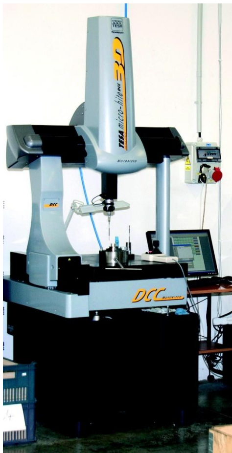
Obr. 86 Souřadnicový měřicí přístroj pro měření polohy [20]
