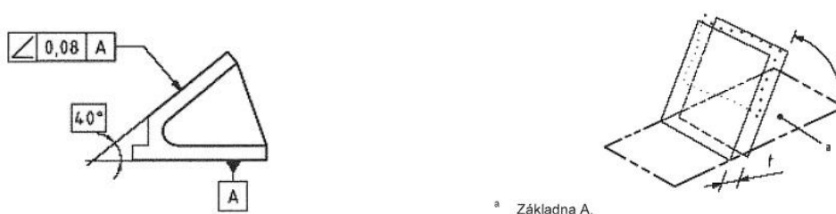
Obr. 39 Označení a vysvětlení geometrické tolerance sklonu dvou rovin [4]
