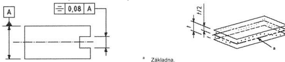
Obr. 46 Označení a vysvětlení geometrické tolerance souměrnosti [4]
