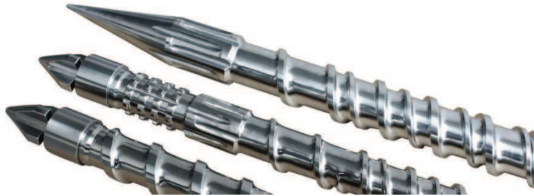
Obr. 7 - Vstřikovací šneky ( www.ank-service-and-parts.ca )
