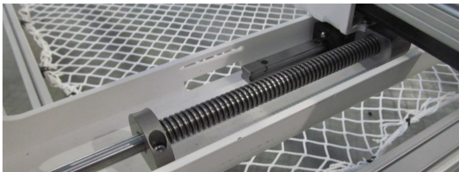
Obr. 12-2 Pohled na uložený pohybový šroub, posouvající dráhu
