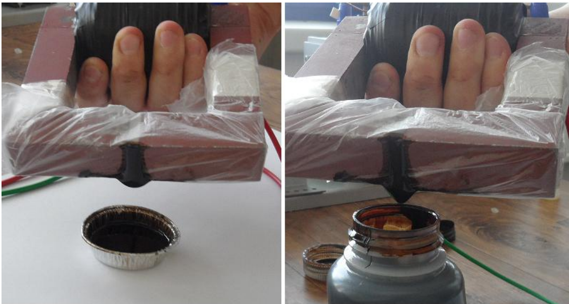
Obr .P.6.: Elektromagnet pro čištění objektů potřísněných magnetickou kapalinou; vlevo - elektromagnet vybuzen, magnetická kapalina migruje k jeho pólům, vpravo - vypnutí buzení, kapalina volně steče do kontejneru
