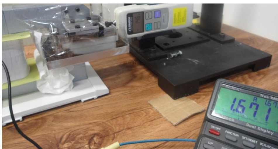
Obr. 6.6.: Příklad měření jednoho bodu statické silové charakteristiky aktuátoru s mezerou vyplněnou ferokapalinou
