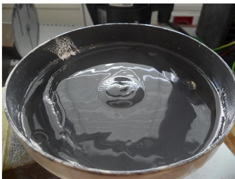
Obr. P.1.: Odpařování nosné tekutiny MR kapalin (patrné na stěnách nádoby)
