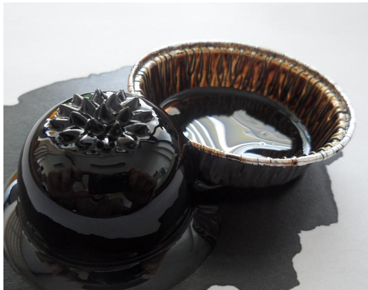
Obr. P.4.: Kontakt ferokapaliny a permanentního magnetu, migrace kapaliny
