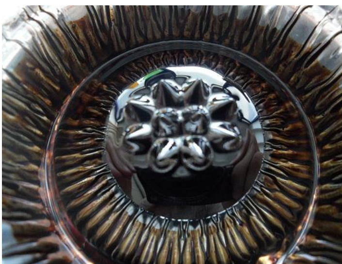
Obr. P.3: Povrchový jev při vystavení ferokapaliny působení externího magnetického pole
