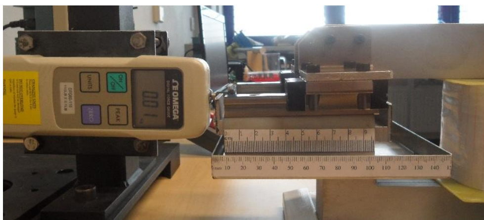
Obr. 6.5.: Sestava pro měření statické silové charakteristiky aktuátoru se vzduchovou mezerou
