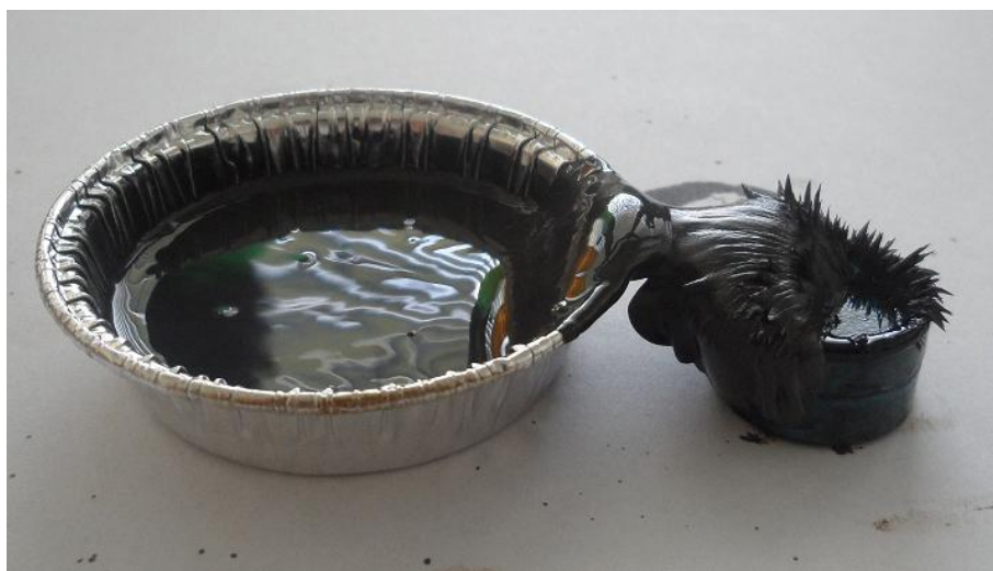
Obr. P.5.: Kontakt MR kapaliny a permanentního magnetu, migrace kapaliny
