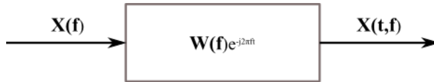
Obrázek 4-1: STFT jako filtrace ve frekvenční oblasti
