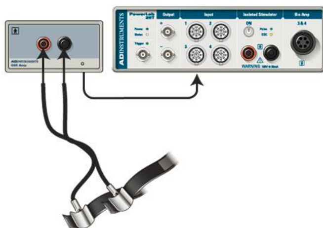
Obrázek 15: Schematické znázornění měřicího přístroje ADINSTRUMENT Power Lab spolu se zesilovačem ML 116 GSR Amp a elektrodami (Zdroj: Benešová, 2011)
