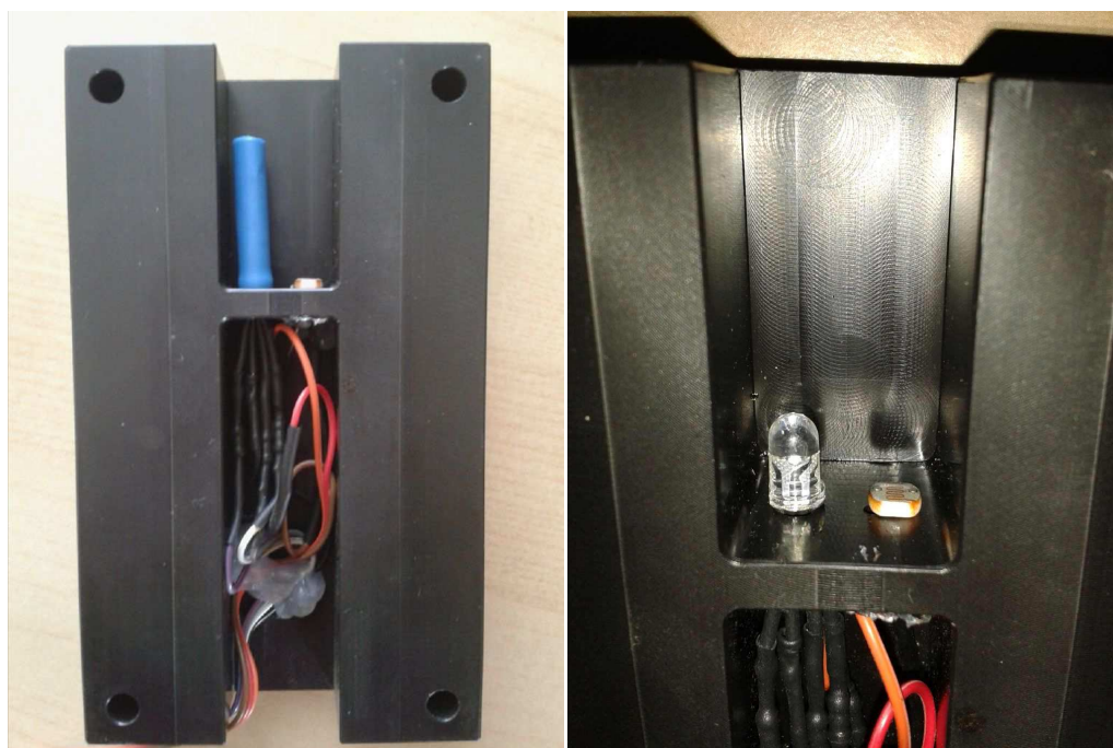
Obr 4.5 Vyrobený senzor barvy
