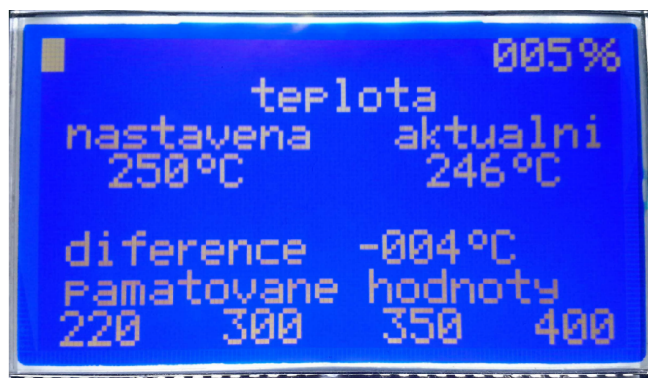
Obr. 19: Zobrazení informací na displeji DOGL128B-6
