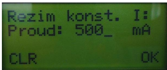
Obr. 30 Zadávání požadované hodnoty proudu
