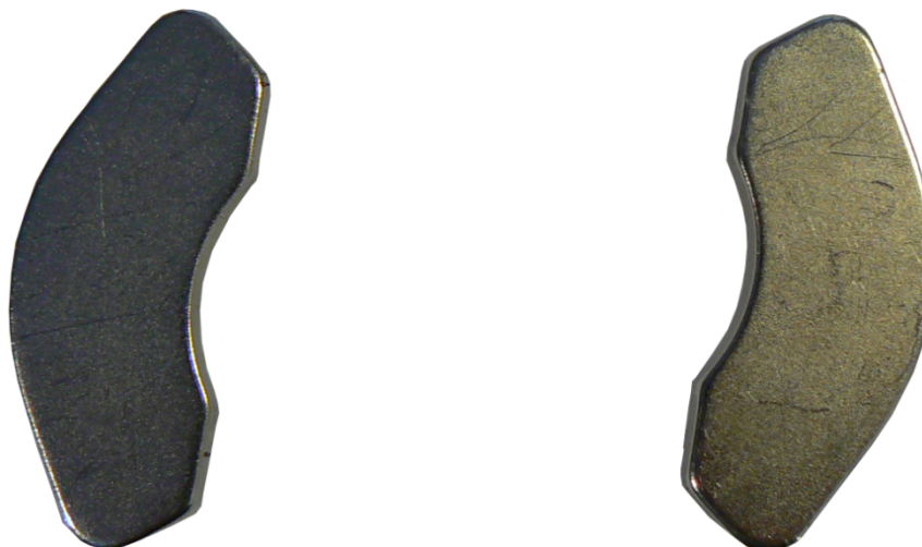
Obr. 20 Použité neodymové magnety Zdroj: vlastní zpracování
