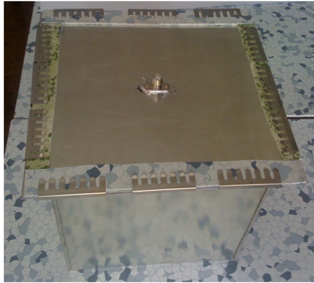
Obr. č. 5 Realizovaný drátový monopól v dutině (cap)
