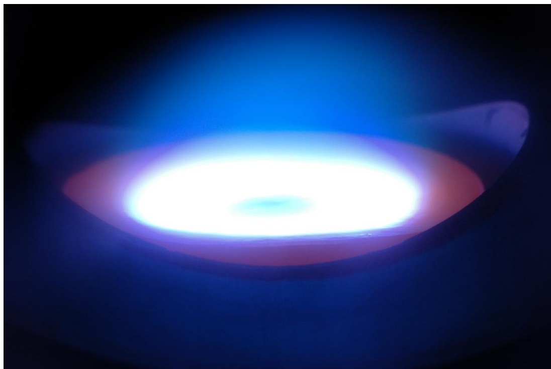
Obr. 4.4 Fotografie horkého terče během pulzní magnetronové depozice.
