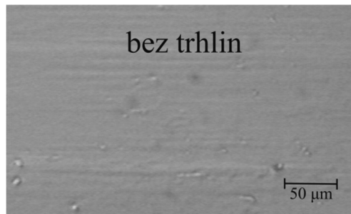
Obr. 5.35: Povrch vzorku po ohybovém testu bez známek vzniku trhlin při deformačním prodloužení \epsilon \approx 0,76\% pořízený z optické části zařízení Fischerscope H100.
