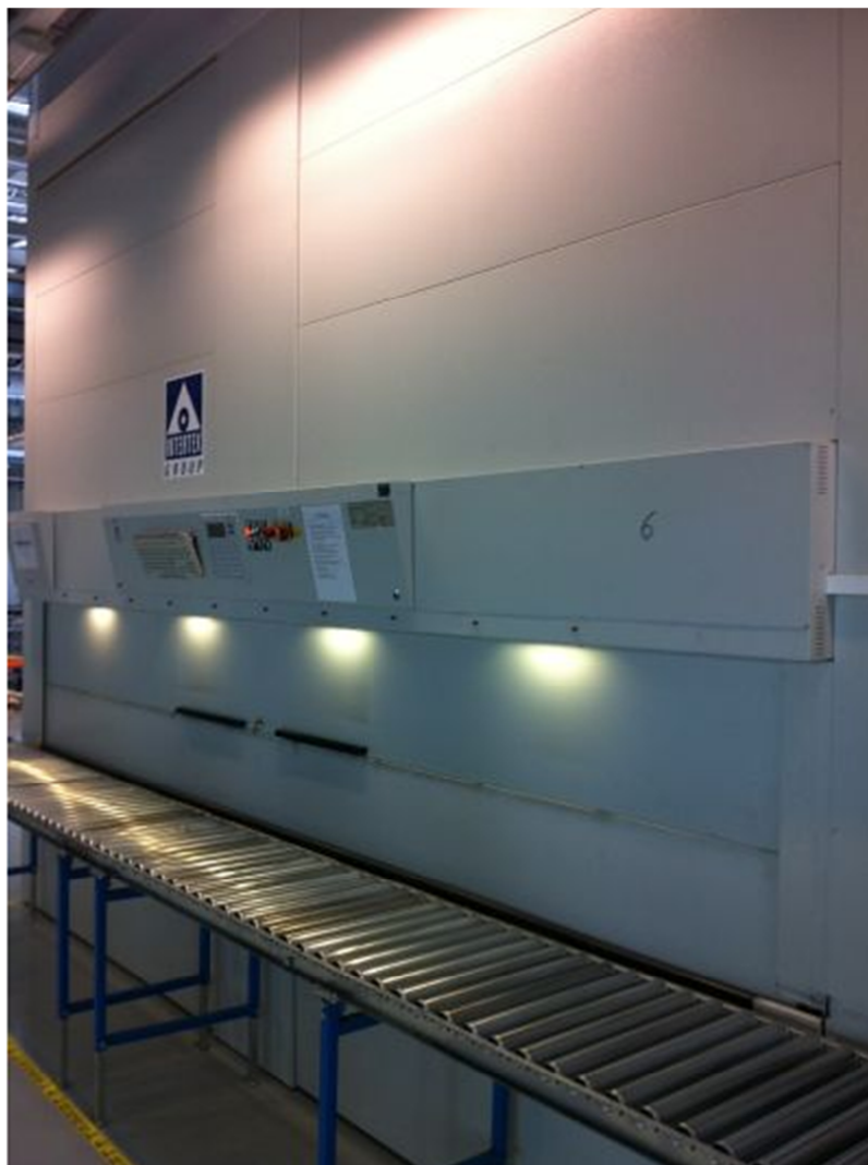
Obrázek 5-17: Pater noster typu Euromat 120-650-381-20-600 [24]
