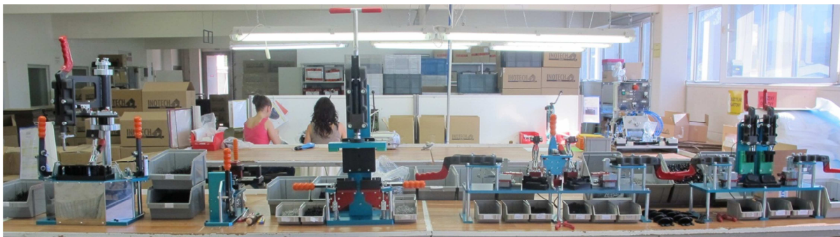
Obrázek 5-3: Ruční pracoviště pro montáž produktu TB ZB Getränkehalter modul
