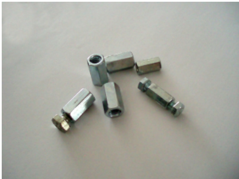
Obrázek 8: Spojovací matice v původním stavu se šrouby (vlastní zdroj)
