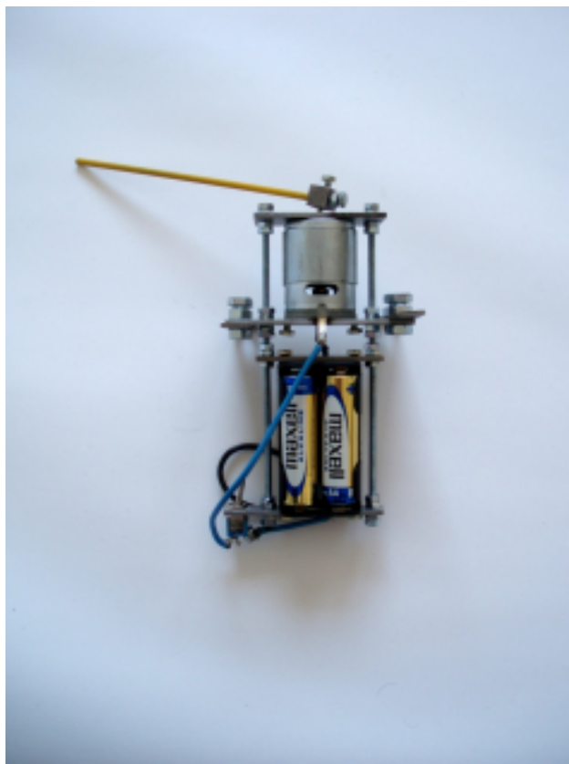
Obrázek 11: Tělo hračky č.1 žlutá, elektromotor a pouzdro na baterie (vlastní zdroj)
