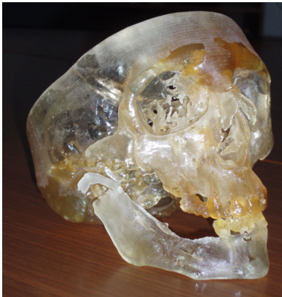
Obrázek č. 14: Spodní čelist vyrobená 3D technologií.
