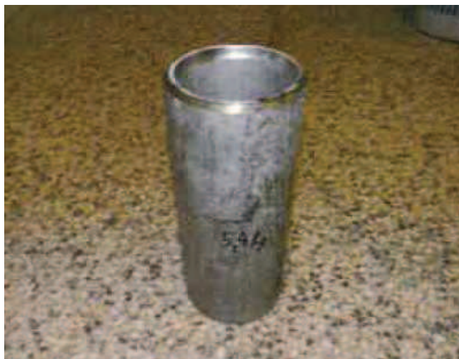
Obr. 2.11 Ocel 08CH18N10T, trubka \varnothing 133 \times 13 mm, délka 250 mm
