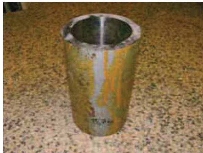
Obr. 2.10 Ocel 22K, trubka \varnothing 150 \times 15 mm, délka 250 mm
