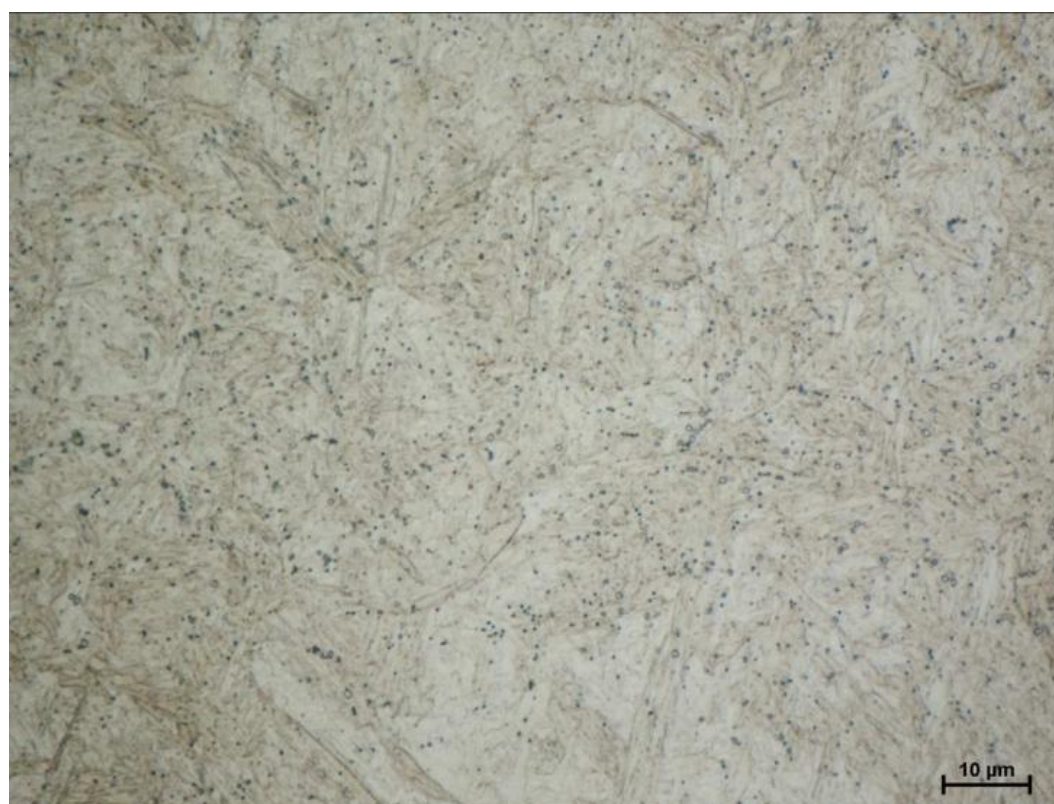
Obr. 61: Mikrostruktura režimu 1 (H+T), Villela-Bain, zv. 1000 x
