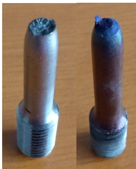
Obr. 11.3: Ukázka vzorků po provedené tahové zkoušce – pokojová teplota, teplota 400 °C
