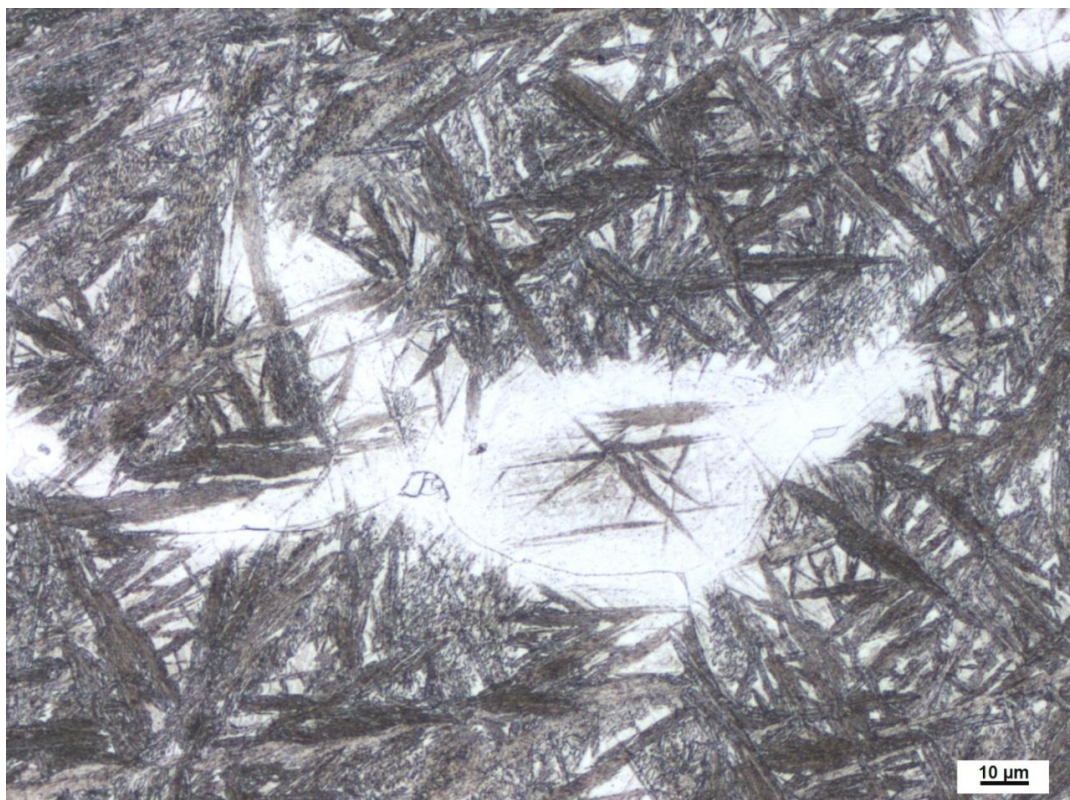
Obr. 75: Mikrostruktura litého stavu modifikované oceli s niobem a borem, 3 % Nital, zv. 500 x
