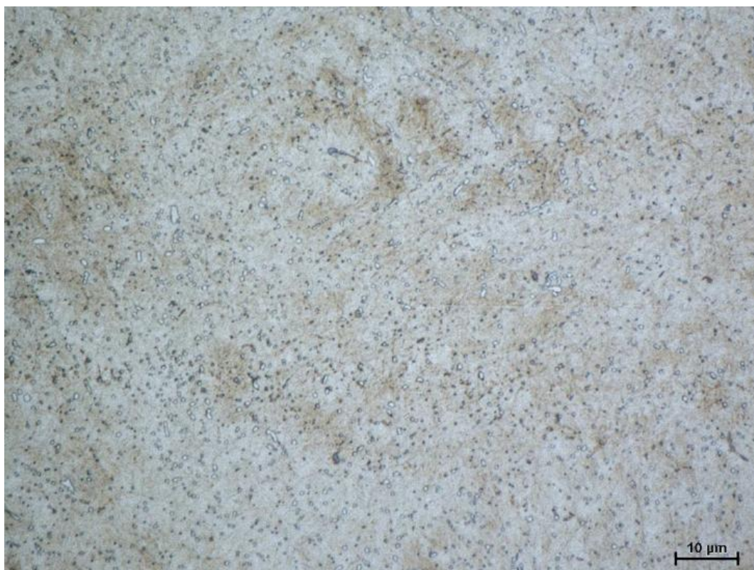
Obr. 62: Mikrostruktura režimu 3 (H+12C+T), Vilela-Bain, zv. 1000 x
