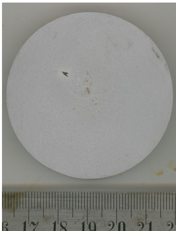
Obr. 76: Makrostruktura kovaného stavu modifikované oceli s niobem a borem
