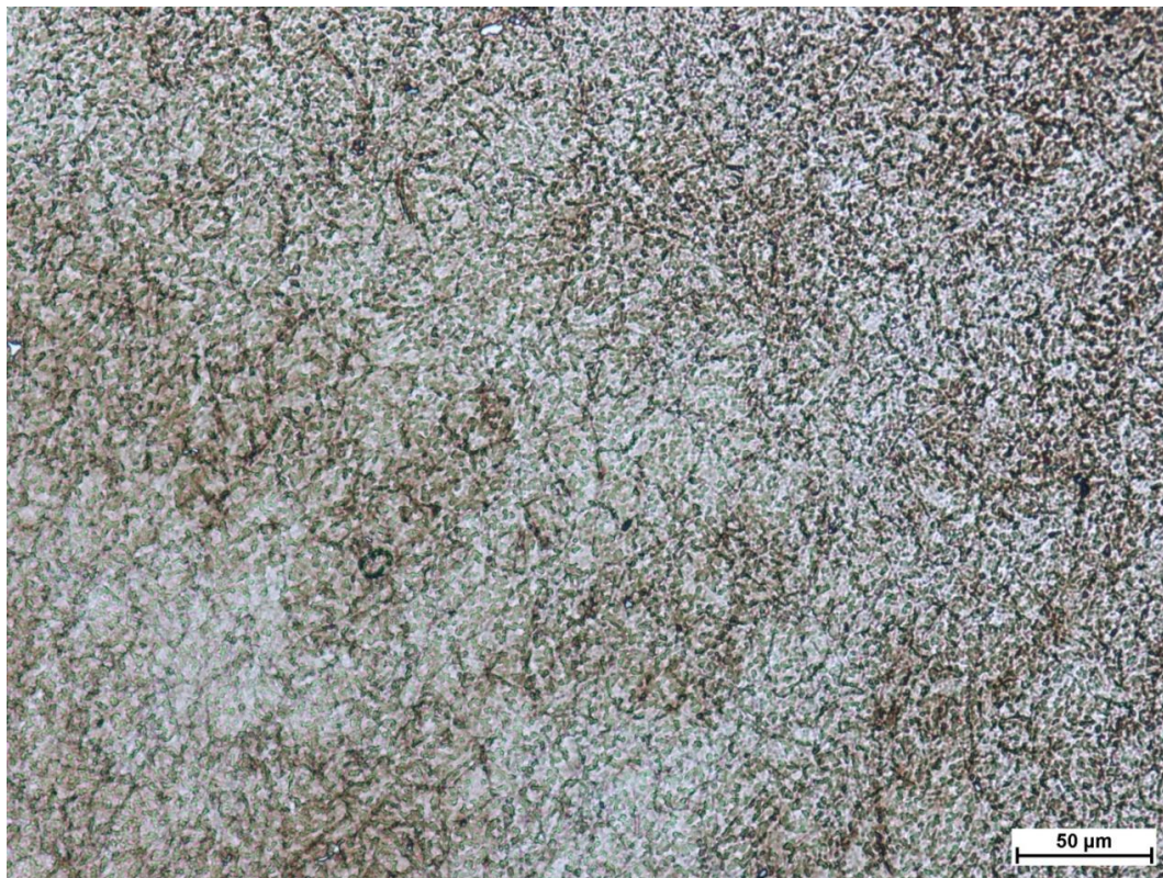
Obr. 78: Snímek pro vyhodnocení velikosti zrna modifikované oceli, příčný řez zv. 200 x
