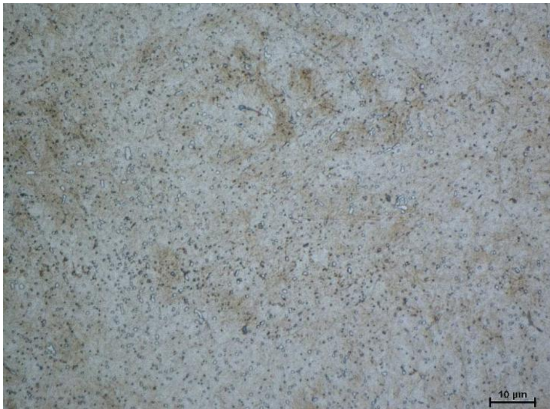
Obr. 58: Mikrostruktura režimu 3 ( H+12C+T ), Villela-Bain, zv. 1000 x
