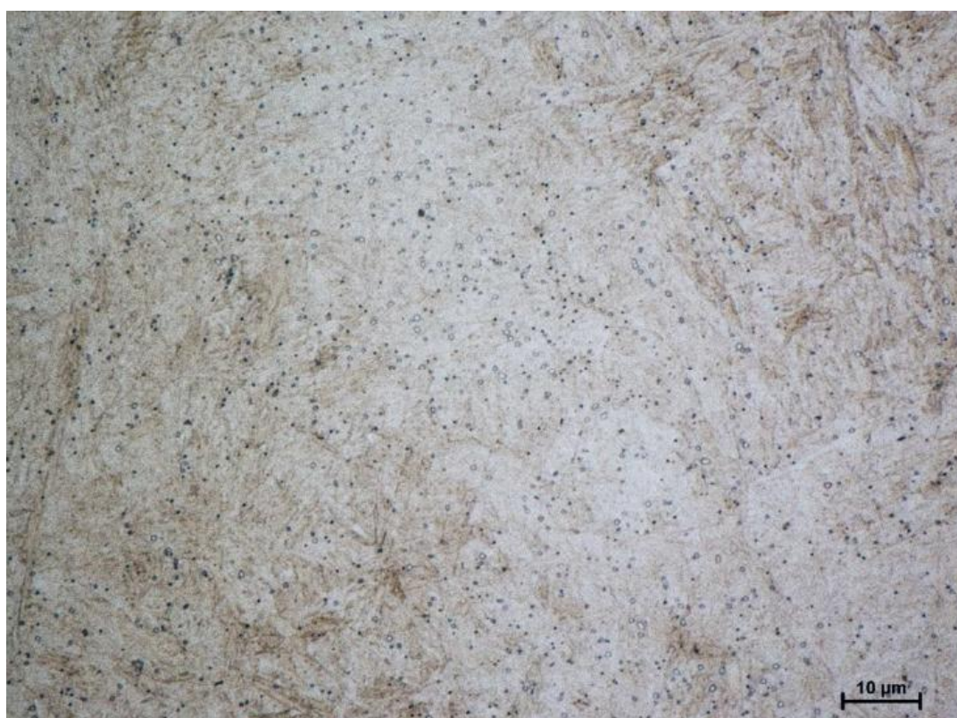
Obr. 63: Mikrostruktura režimu 4 (H+24C+T), Vilela-Bain, zv. 1000 x
