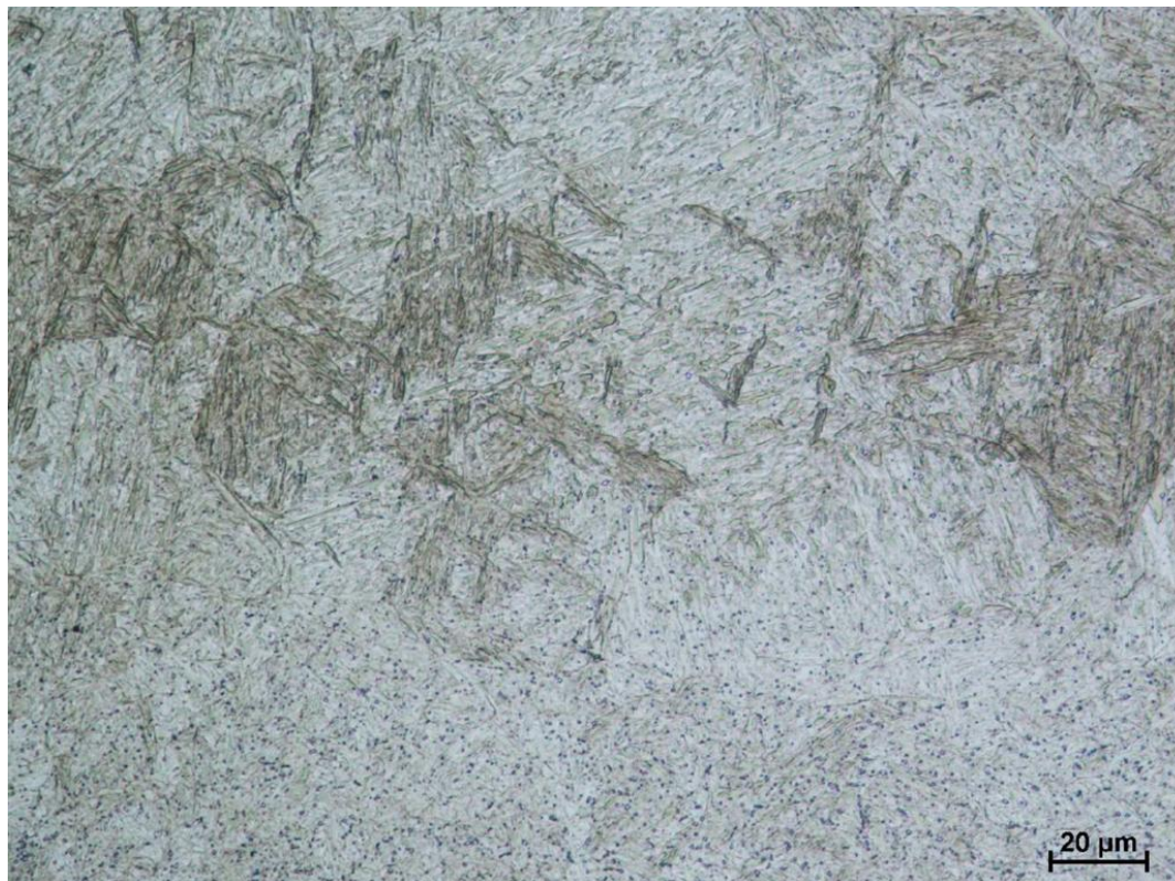
Obr. 54: Mikrostruktura režimu 1 (H+T), Vilela-Bain, zv. 500 x
