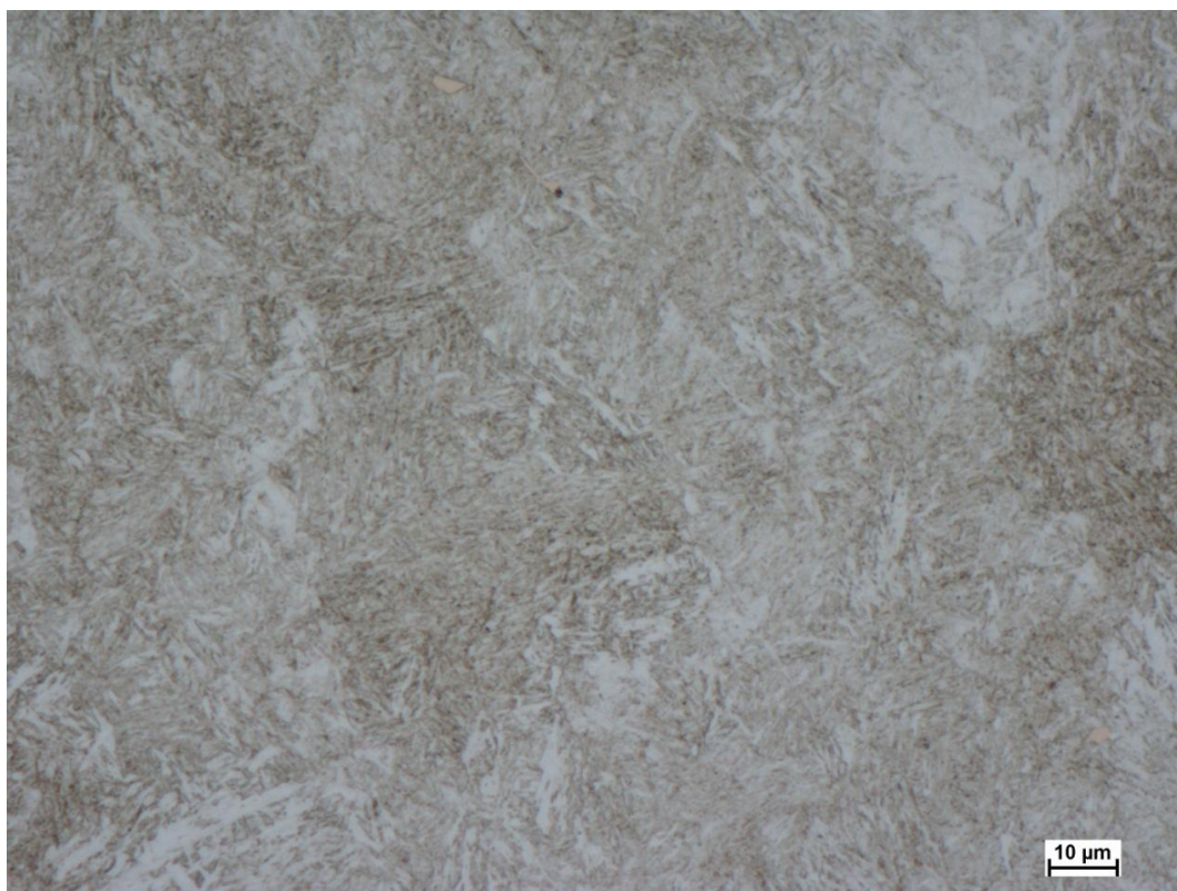
Obr. 81: Mikrostruktura režimu 2 (H+6C+T) modifikované oceli, Villela-Bain, zv. 500 x
