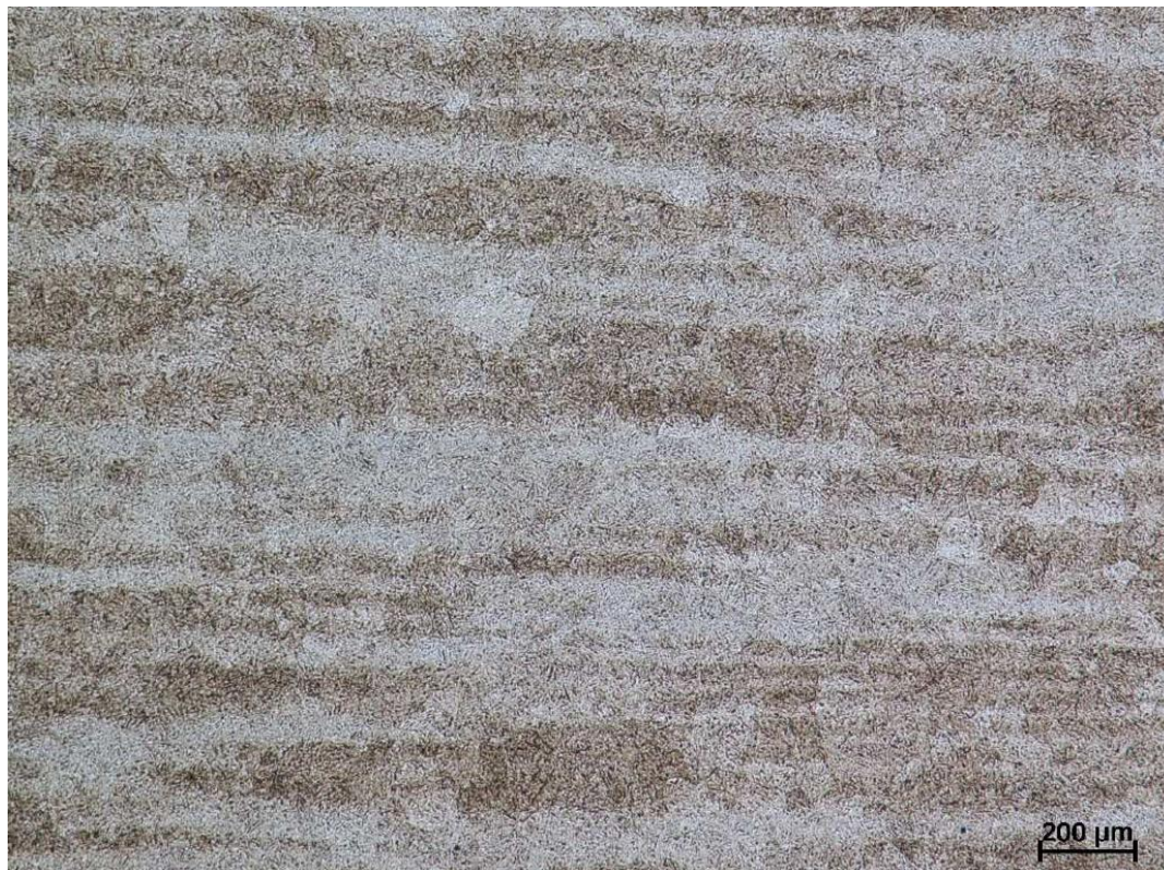
Obr. 52: Mikrostruktura režimu 1 (H+T), Vilela-Bain, zv. 50 x
