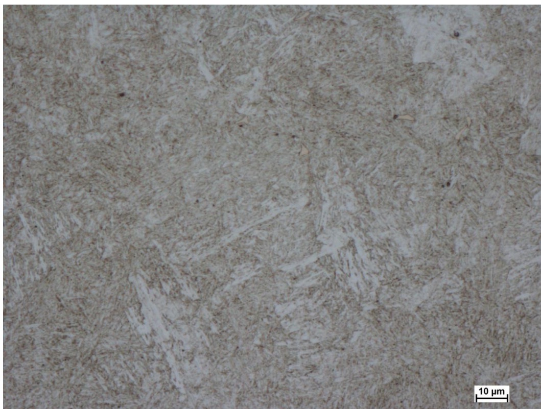
Obr. 79: Mikrostruktura režimu 1 (H+T) modifikované oceli, Villela-Bain, zv. 500 x
