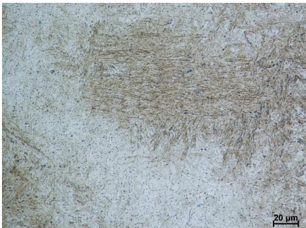
Obr. 57: Mikrostruktura režimu 3 (H+12C+T), Vilela-Bain, zv. 500 x
