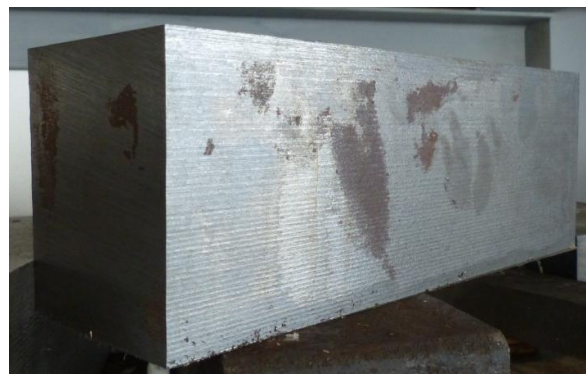
Obr. 6.1: Blok nástrojové oceli X37CrMoV5-1
