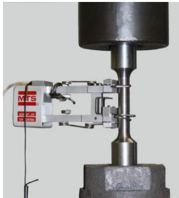
Obr. 11.2: Zkouška tahem – měřicí soustava
