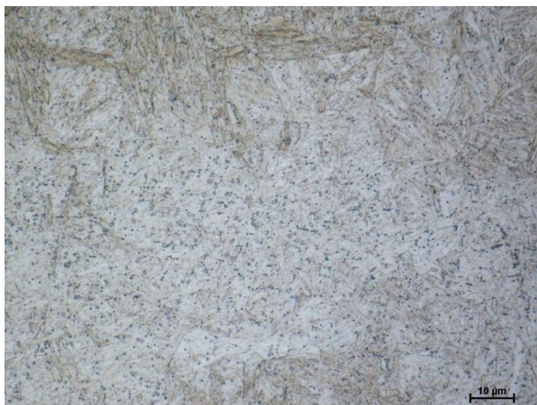
Obr. 55: Mikrostruktura režimu 1 (H+T), Vilela-Bain, zv. 1000 x
