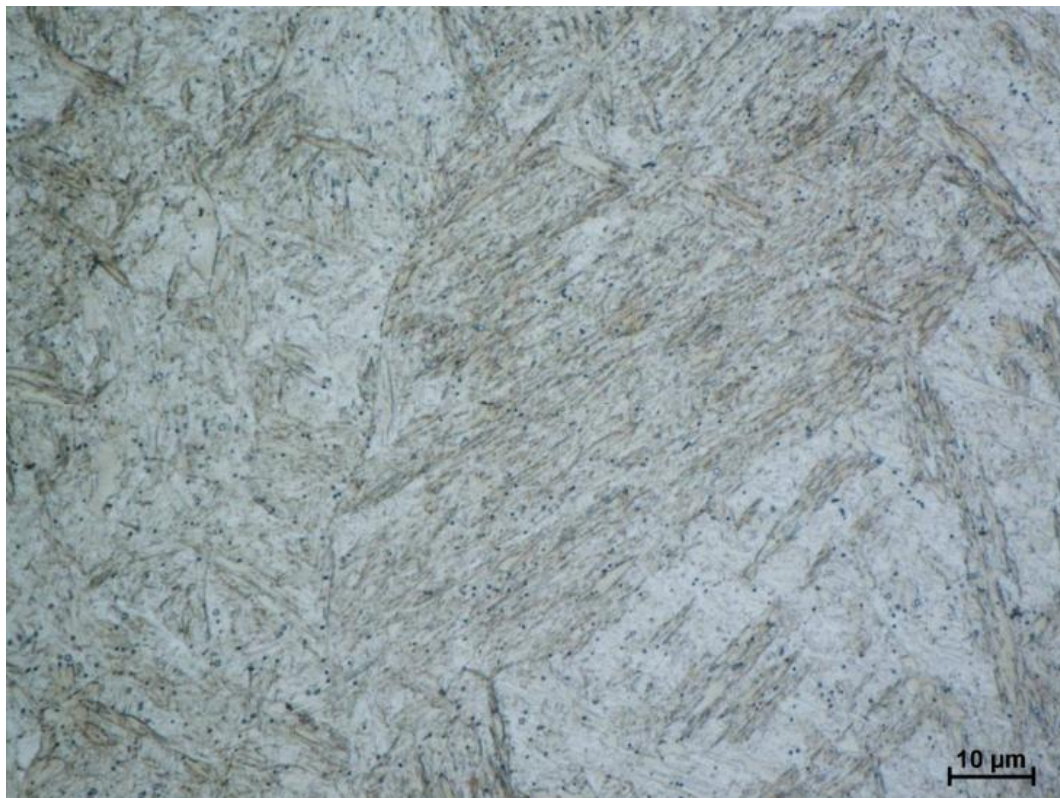
Obr. 56: Mikrostruktura režimu 1 (H+T), Vilela-Bain, zv. 1000 x
