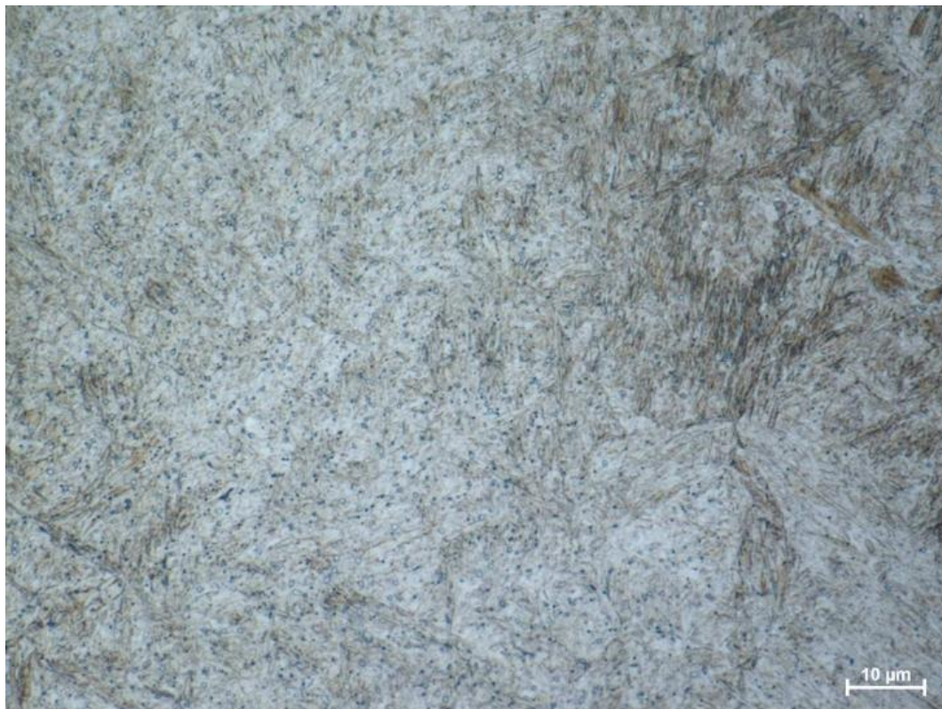
Obr. 60: Mikrostruktura režimu 4 (H+24C+T), Villela-Bain, zv. 1000 x
