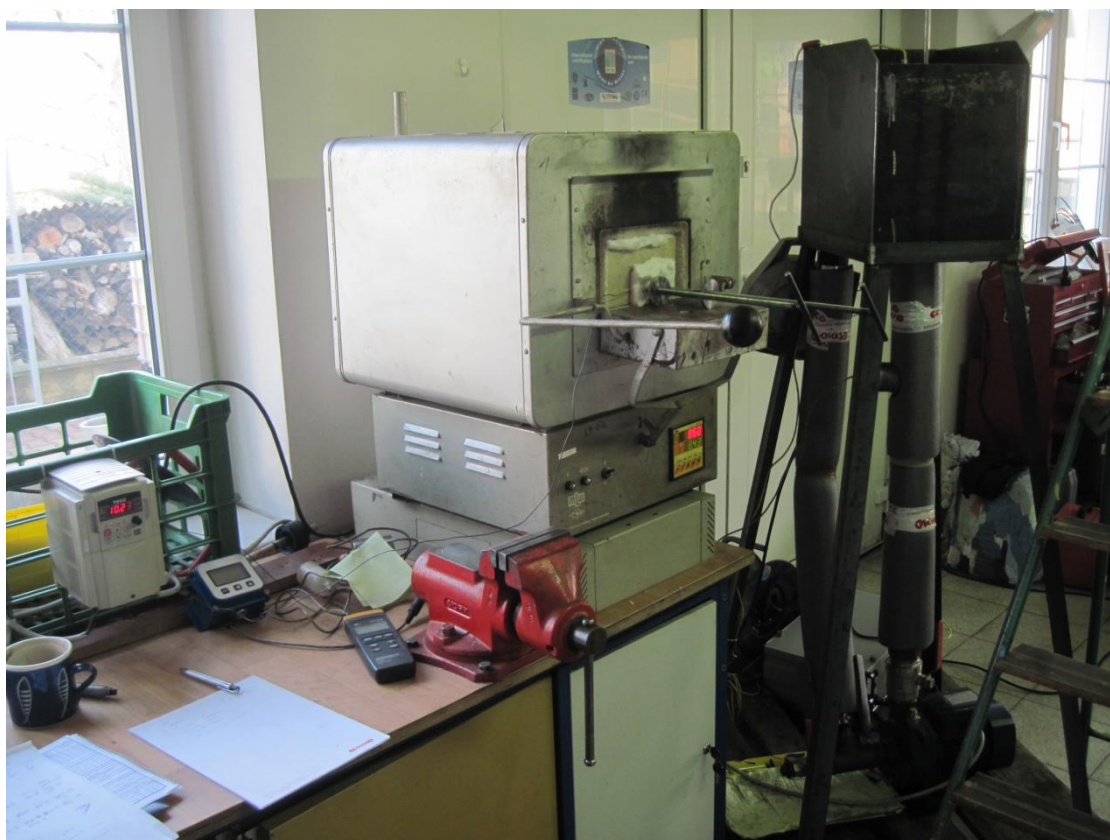
Obr. 11-2: Kompletní sestava experimentálního zařízení s veškerým měřicím a regulačním zařízením vč. laboratorní pece
