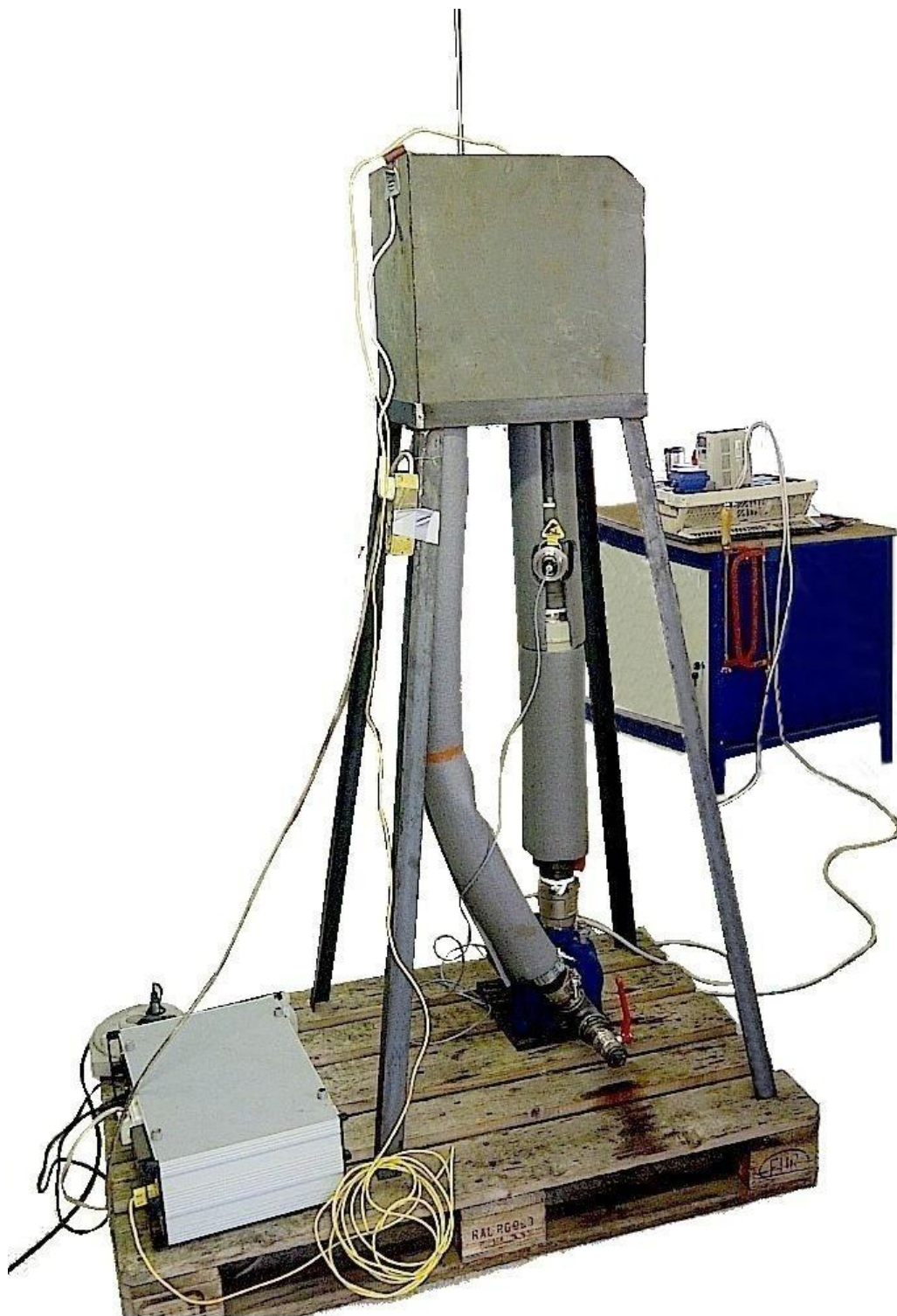
Obr. 9-6: Kompletní sestava experimentálního zařízení se zapojenými měřicími a regulačními přístroji (regulace teploty, měřič průtoku, frekvenční měnič)
