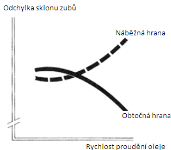
Obr. 4-3: Vliv proudění oleje na odchylku sklonu zubů [6]
