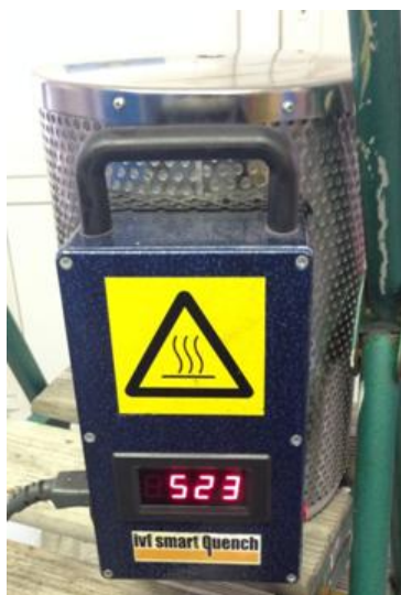
Obr. 10-2: Detail pece pro ohřev Quench sondy na danou teplotu
