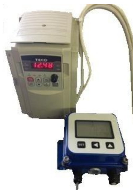
Obr. 9-3: Frekvenční měnič (vlevo) a měřící jednotka průtokoměru (vpravo)
