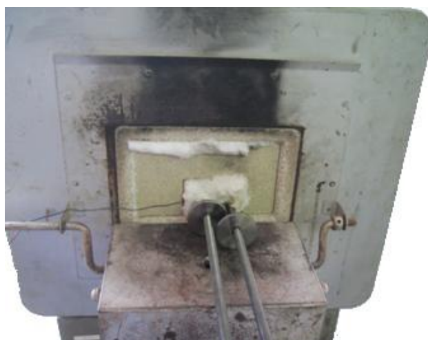
Obr. 11-4: Pec s utěsněným otvorem (deskou ze žáruvzdorného materiálu GRENAMAT AS a izolační vatou z materiálu SIBREX) a vloženými vzorky do pecního prostoru
