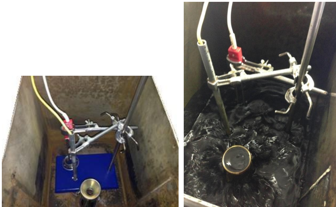
Obr. 9-4: Ustavení laboratorního stojanu s ponorným ohřivačem a termočlánkem pro regulaci teploty oleje v nádrži a stojan určený pro ponořování quench sondy do lázně a fotografie zaplavené nádrže s funkčním vířením
