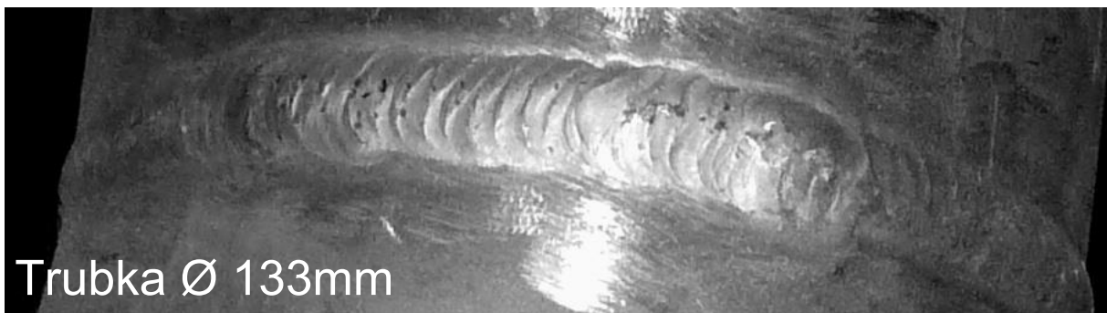
Obr. 5-30 – Vzhled svarů při kontrole vizuální přímou metodou
