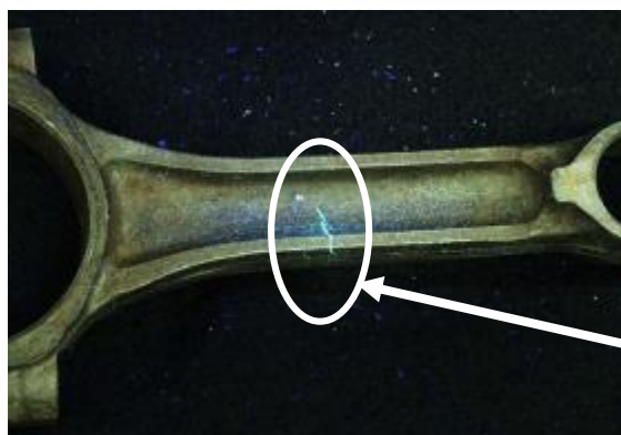
Obr. 3-17 – Fluorescenční indikace povrchové vady [16]
