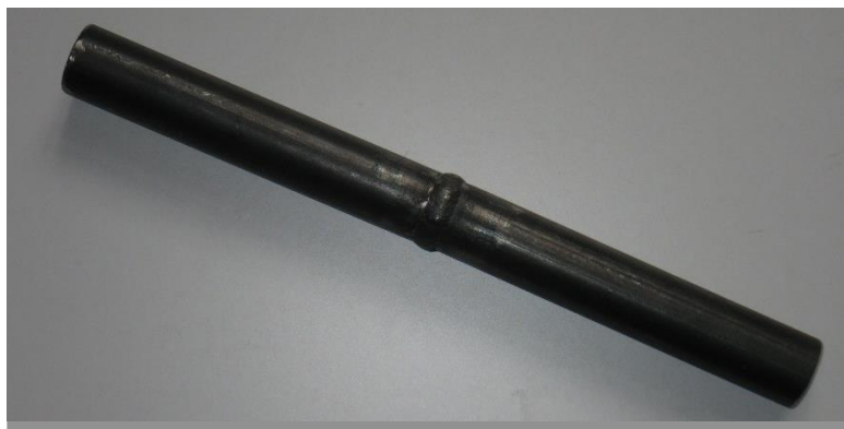
Obr. 5-1 – Zkušební kus (trubka průměr 30mm)
