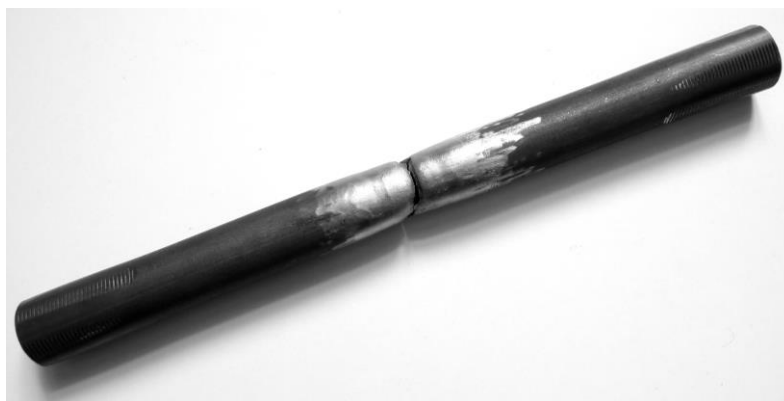
Obr. 5-6 – Zkušební vzorek po přetržení zkouškou tahem (trubka \varnothing 30mm )
