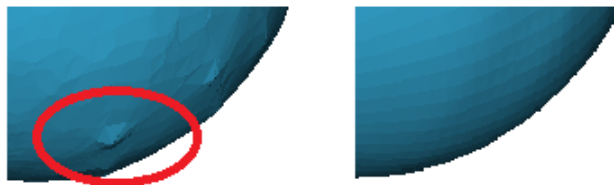
Obrázek 13: Výřez z obrázku koule vyhlazené pomocí implicit fairing metody (vlevo) a základního laplaciánského vyhlazování (vpravo) po 10 iteracích. Zdroj: programové výstupy.
