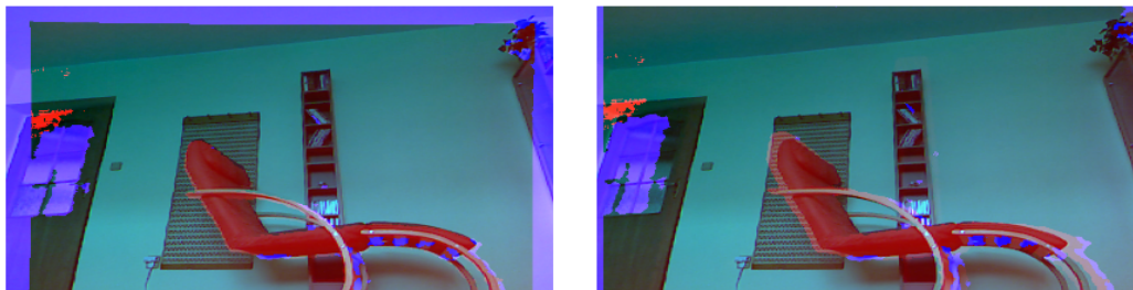
Obrázek 3.2: Snímky ze senzoru MS Kinect znázorňující vztah mezi barevným obrazem a hloubkou. Vlevo po použití mapovací funkce, vpravo bez mapování.
