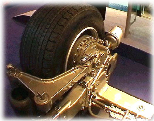
Obr. 2-7 Poháněný náboj trolejbusu, Irisbus Cavis [22]
