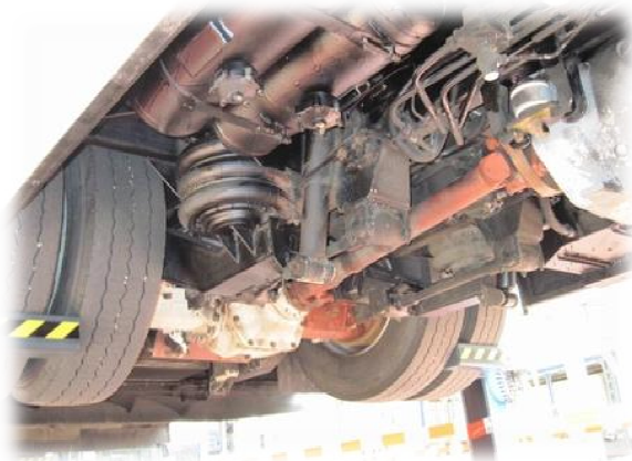
Obr. 2-2 podvozek trolejbusu Škoda, hnací hřídel, sklotexitivá spojka [24]
