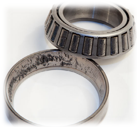
Obr. 3-2 Únavové poškození ložiska (pitting) [26]
