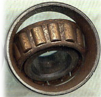
Obr. 3-4 Ložisko poškozené korozí [27]
