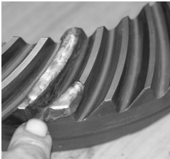
Obrázek 27 : Oprava zubů zavařením [47]
