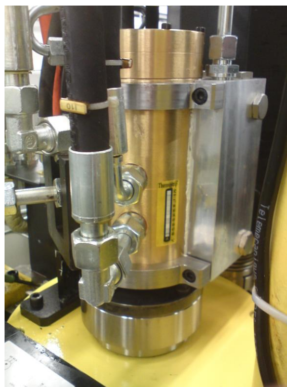
Obr. 7.17: Stávající jednotka s chladičem na stroji (vpravo štítek zaznamenávající teplotu zařízení)
