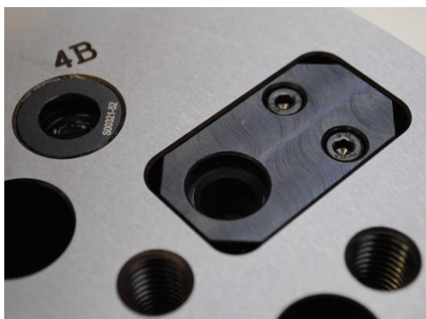
Obr. 6.17: Namontované seřizovací zařízení
