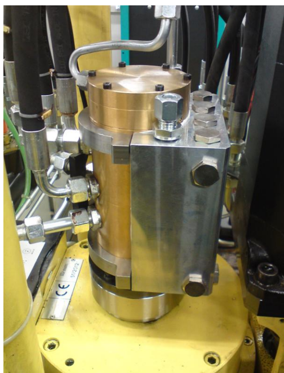
Obr. 7.17: Stávající jednotka s chladičem na stroji (vpravo štítek zaznamenávající teplotu zařízení)
