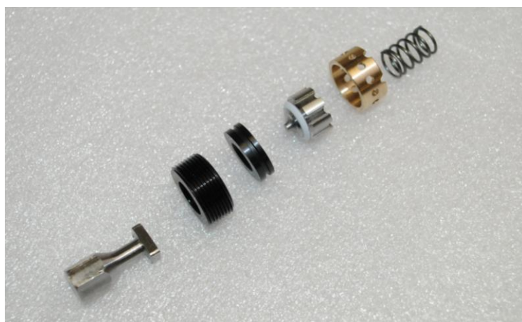
Obr. 3.30: Vyrobenné díly seřazené v pořadí montáže. Vpravo je znázorněna aplikace klíče do drážky v matici pomocí zápichu pro o-kroužek, který se osadí následně po dotažení a vyjmutí klíče
