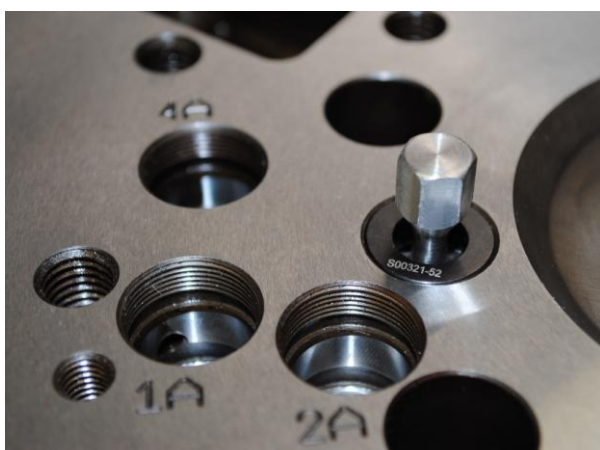
Obr. 6.15: Montáž rychlospojky pomocí klíče
