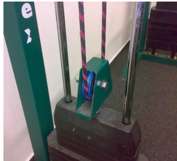
Obrázek 18.: Přenos síly - pletené lanko
