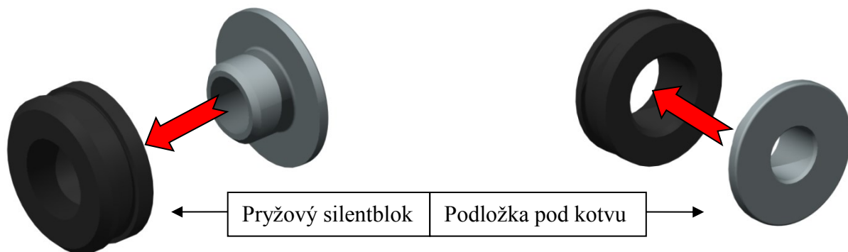
Obrázek 36.: Pryžové silentbloky pro vypružení hlavního rámu
