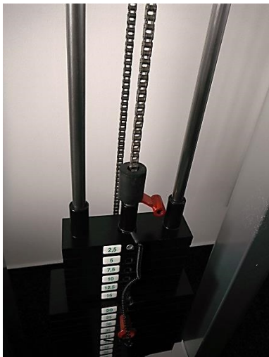
Obrázek 17.: Přenos síly - válečkový řetěz
