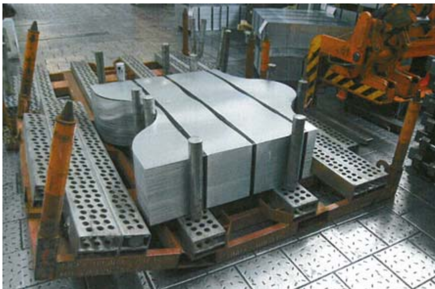
Obr. 10 Deformace palety vzniklá manipulací
