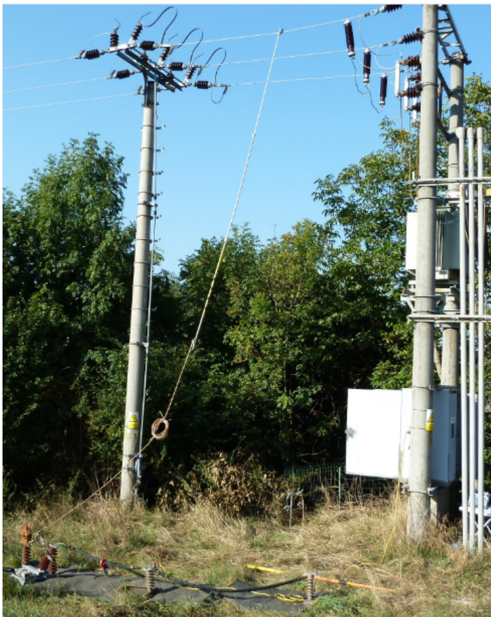
Obrázek 29: Experimentální zemní spojení s přizemněním postižené fáze, foto autor
