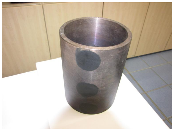
Obrázek 5.6: Magnetická válcová dutá vsázka s černými matnými kruhy určenými k měření teploty na povrchu vsázky optickým pyrometrem při známé emisivitě \varepsilon [-]
