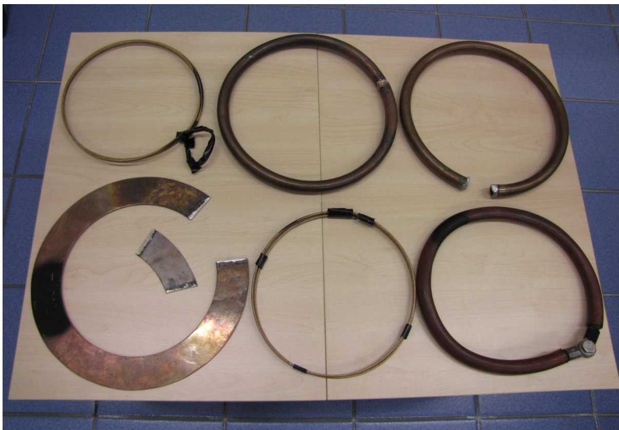
Obrázek 5.7: Nové přídavné konstrukční prvky – 1. řada zleva (nahore): dva měděné závitky uzavřené, měděný trubkový dutý vodič uzavřený, měděný trubkový dutý vodič otevřený, 2. řada zleva (dole): plochý měděný prstenec otevřený s vyřízlou výsečí, dva měděné závitky otevřené, plný vodič se šroubovým spojem uzavřený
