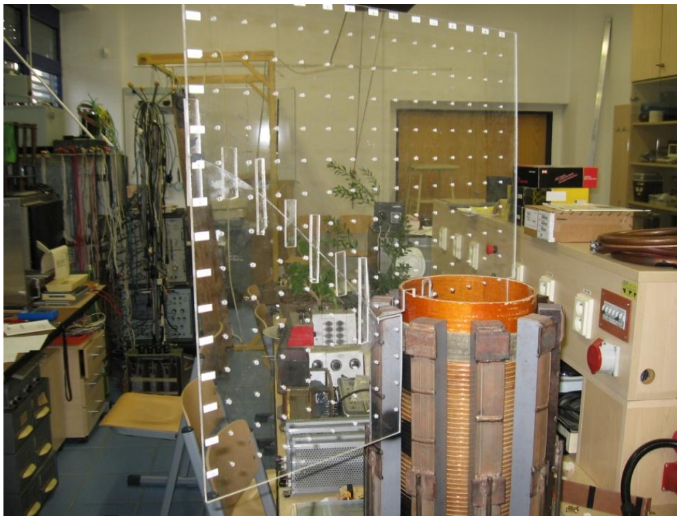
Obrázek 7.4: Měřicí deska nasazená na induktoru stíněném svazky transformátorových plechů
