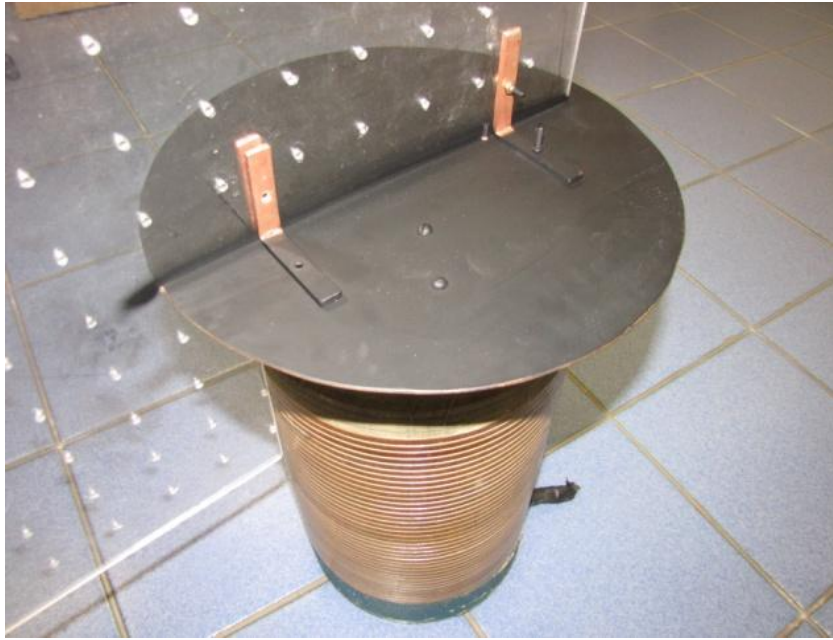
Obrázek 7.7: Příprava na měření – měděná kruhová deska nasazená na induktoru je nastříkána černou matnou barvou za účelem měření teploty optickým pyrometrem
