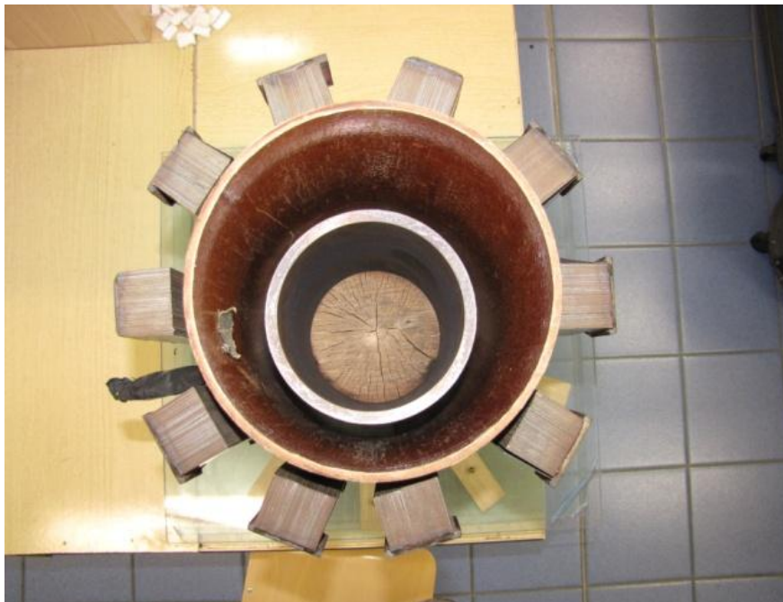
Obrázek 7.8: Příprava na měření – uspořádaná vsázka, induktor, stínění (od středu vně)
