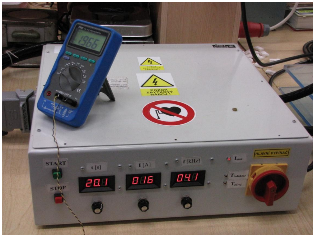
Obrázek 7.2: vysokofrekvenční pulzní zdroj FRQET 5 – na zdroji jsou nastaveny tyto parametry: f = 4,1 kHz, I = 16 A, t = 20,1 s ( f je frekvence napájecího proudu induktoru, I je napájecí proud induktoru na zdroji a t je doba spuštění zdroje (doba ohřevu))
