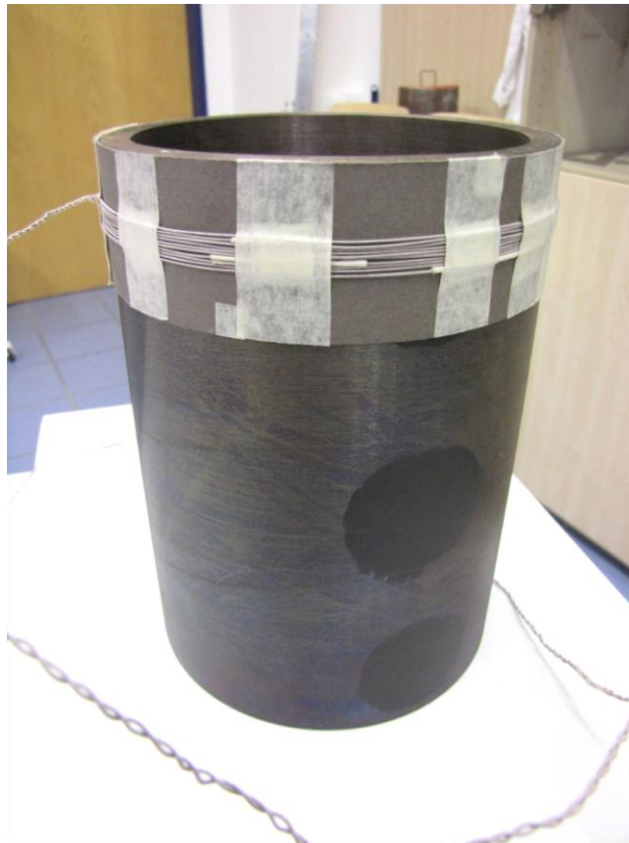
Obrázek 6.10: Měřicí cívka velkého průměru nasazená na vsázce
