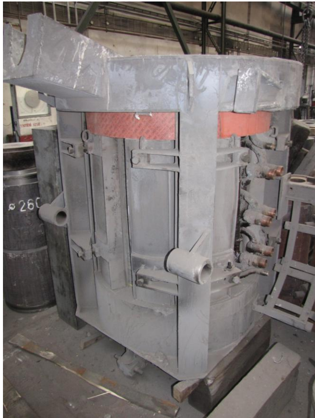
Obrázek 9.8: Příklad induktoru vyjmutého z vakuové kelímkové indukční pece (1000 Hz, 1000 kg) s dobře viditelnými svislými svazky transformátorových plechů
