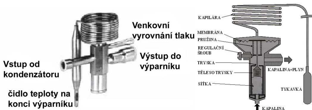
Obr. 3.10 Termostatický expanzní ventil TEV
