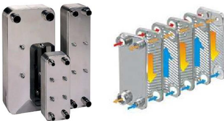
Obr. 3.8 Ukázka a složení deskového výměníku
