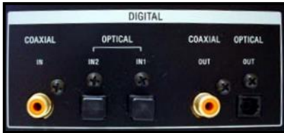
Obrázek 7 – panel s SPDIF vstupy a výstupy
