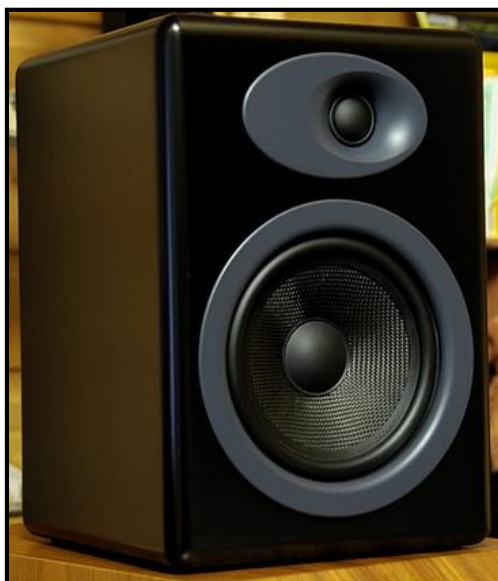
Obrázek 33 – levý reproduktor Audioengine A5 s horní hedvábnou a spodní kevlarovou membránou (6 000Kč)
