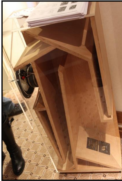
Obrázek 48 – řez hornovým reproduktorem
