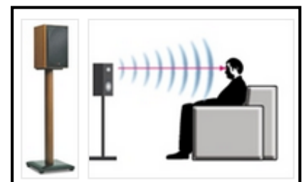
Obrázek 58 – doporučená výška předního kanálu
