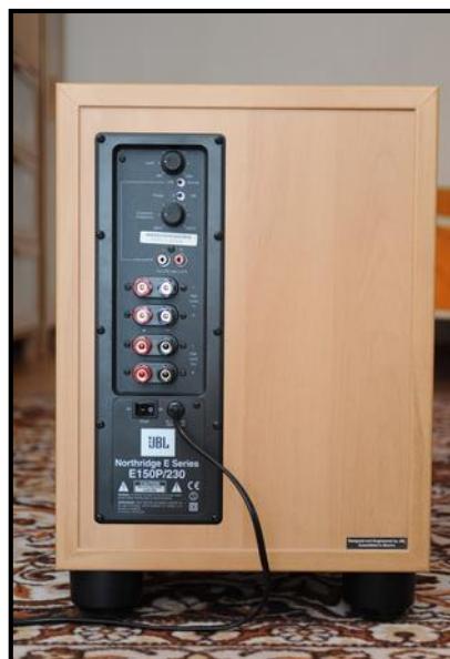
Obrázek 39 – zadní panel s možnostmi úpravy zvukového signálu skrze aktivní výhybku na subwooferu JBL (14 000 Kč)
