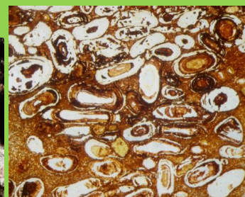
Výbrus se sideritovými oolity ze sideritové železné rudy z Březiny u Rokycan. Velikost oolitů je asi 1,5 mm.
