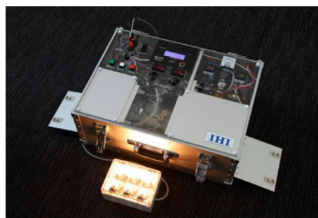
Obr. 3-6: Zdroj s mikroturbínou, zdroj: [28]
