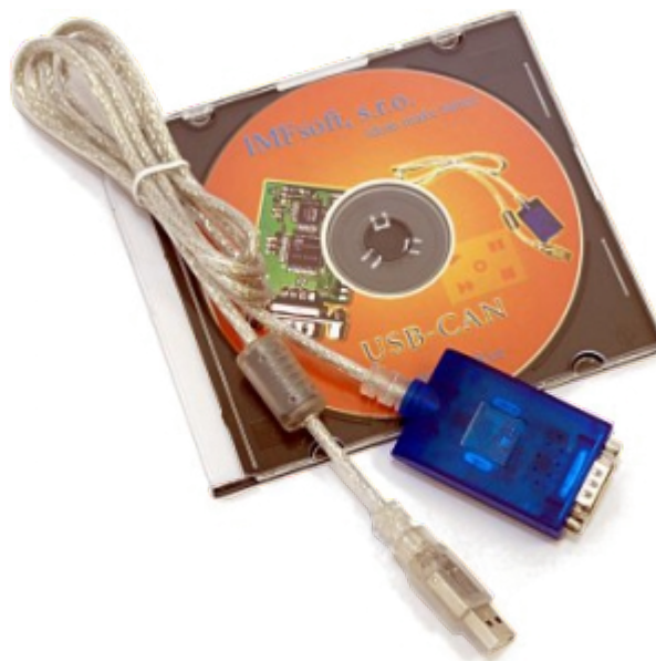
Obr. 18: Analyzátor USB-CAN Adapter TRIPLE drivers V4.2 s instalačním CD [10]
