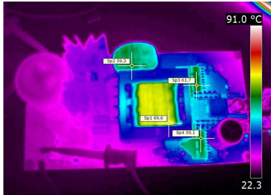
Obr. 1.2.1 Teplotní snímek zdroje PMP5967 [13]
