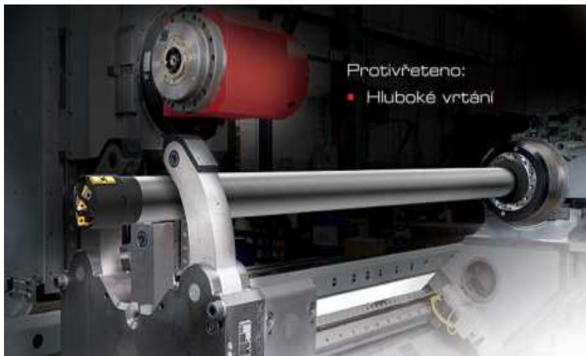
Obrázek 34: Vrtací hlavice upnutá v obrobkovém vřetenu podepřená lunetou [4]
