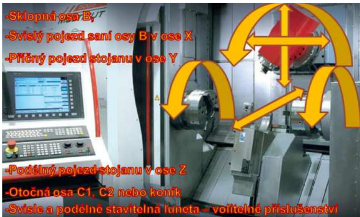
Obrázek 30: Kinematické uspořádání stroje Multicut 630[3]
