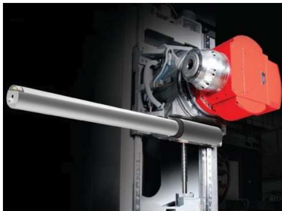
Obrázek 32: Vrtací tyč upnuta v adaptéru [4] Obrázek 33: Přívod emulze do adaptéru [4]
