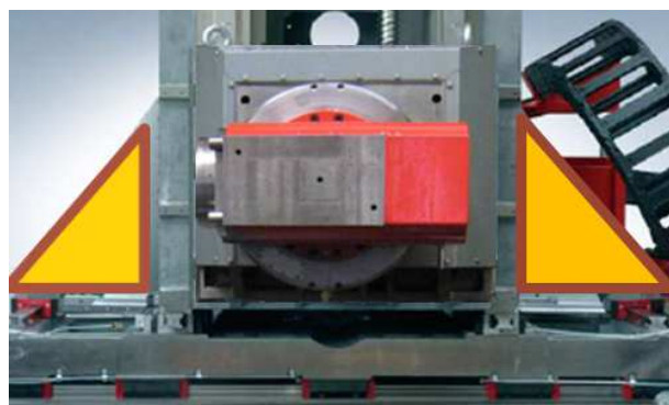
Obrázek 22: Zvýšená tuhost v ose Z[3]
