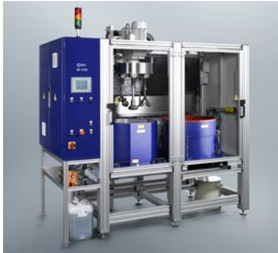
Obr. 2-6 Stroj pro vlečné omílání [25]
