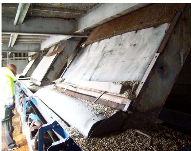
Obr. 14 Odtříděná frakce, která je dále dopravována na venkovní třídící (7. úroveň)
