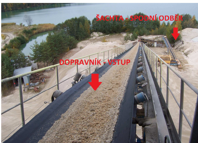
Obr. 6 Pohled na dopravník na vstupu materiálu
