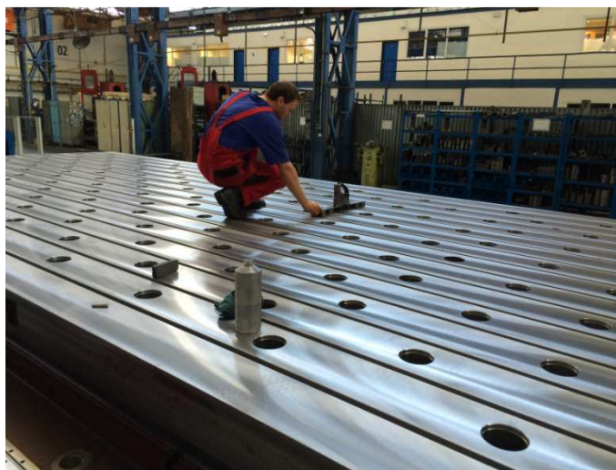
Obr. 7 Měření příčných řezů pomocí digitální libely
