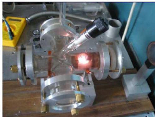
Obr. 7-1 Foto reaktoru ve kterém probíhá laserová ablace
