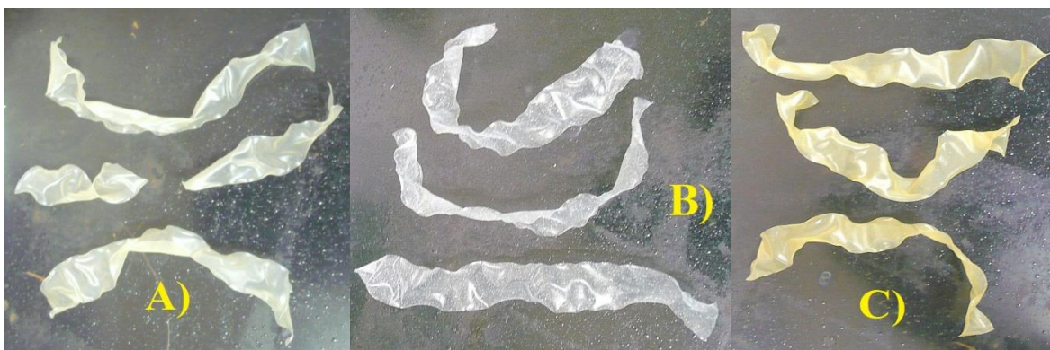
Obr. 31 Vzorky folií s plnivý: A) Kaolin DS1 B) nanosilika C) Sabenil, které prodělaly hodinové loužení ve vodní lázni a poté sušení po dobu jednoho týdne.
