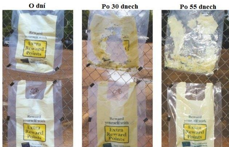
Obr. 4 Pokus s termodegradací sáčků s aditivem TDPA (horní část obr.) a bez aditiva (dolní část obr.). Zdroj [17]
