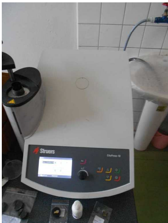
Obr. č. S 2 - Stroj pro zalévání vzorků za horka od firmy Struers
