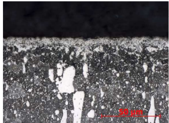
Obr. č. MN61 ocel Sverker 3 – 620°C - 24 hodin, zvětšeno 500x
