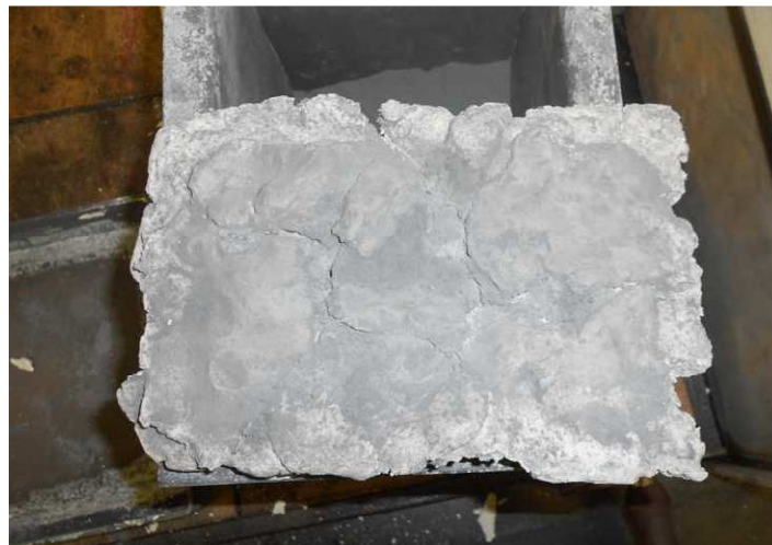
Obr. č. N7 - Aktivátor – po proběhnutí nitridace a vyjmutý z nitridační krabice
