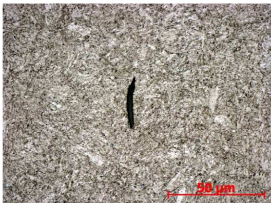
Obr. č. 13 - ocel 31CrMoV9 – podélný řez, zvětšeno 500x
