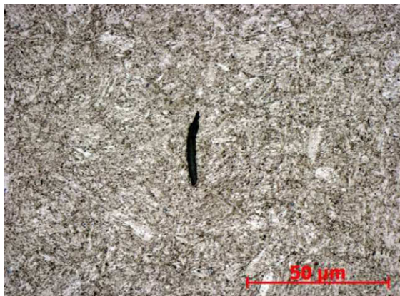
Obr. č. MZ 2 – ocel 31CrMoV9 – podélný řez - zvětšeno 500x
