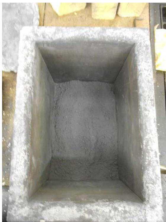
Obr. č. N1 - Krabice pro nitridaci - navrstven nitridační prášek na dno krabice
