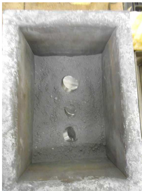
Obr. č. N3 - Krabice pro nitridaci – na aktivátor navrstven další nitridační prášek a umístěny vzorky
