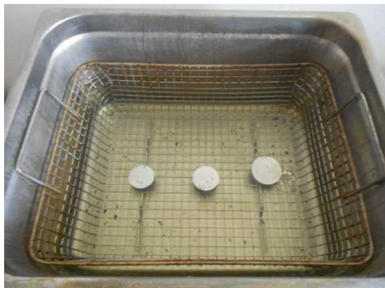
Obr. č. S 1 - Ultrazvuková čistička – umístění vzorků v roztoku přípravku Syntasol 310
