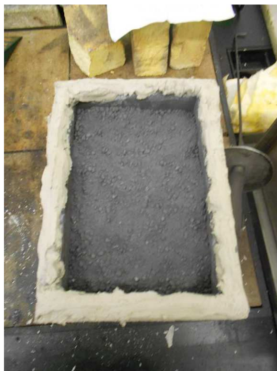
Obr. č. N4 - Krabice pro nitridaci – na vzorky navrstven zbývající nitridační prášek a okraje krabice nemazány těsnícím tmelem
