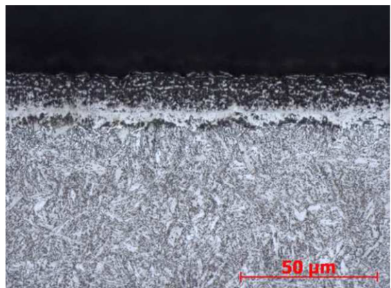
Obr. č. MN3711 ocel 31CrMoV9 - 620°C - 24 hodin, zvětšeno 500x
