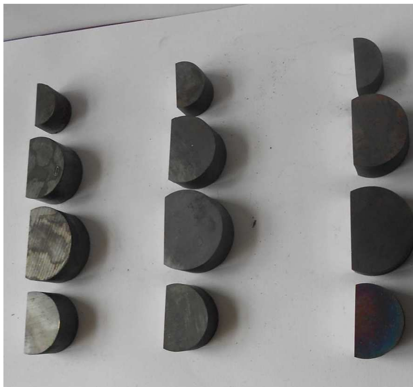
Obr. č. NVZ 2 - Vzorky po nitridaci – čas nitridace 24 hodin + 3 hodiny - ochlazování v peci. Sloupce z leva do prava: 520°C , 560°C, 620°C. Oceli řazené odspodu nahoru: C35, 31CrMoV9, 34CrAlNi7, Sverker 3.
