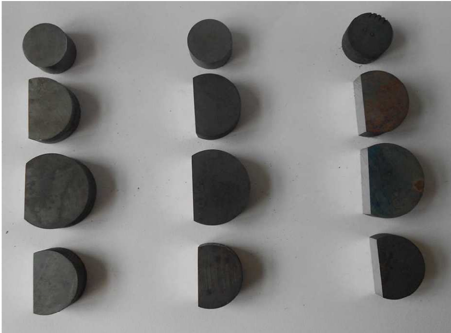
Obr. č. NVZ 1 - Vzorky po nitridaci – čas nitridace 8 hodin + 3 hodiny - ochlazování v peci. Sloupce z leva do prava: 520°C , 560°C, 620°C. Oceli řazené odspodu nahoru: C35, 31CrMoV9, 34CrAlNi7, Sverker 3.
