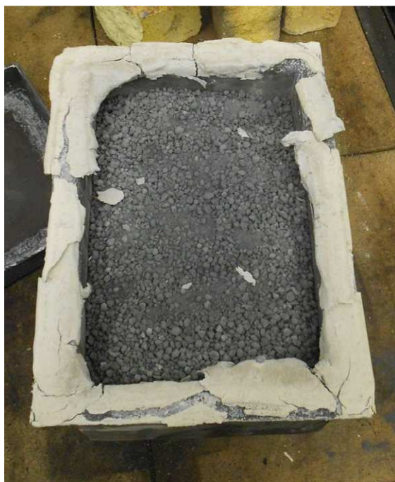
Obr. č. N6 - Krabice pro nitridaci – po vyjmutí z pece a sejmutí víka, po proběhnutí jednoho nitridačního cyklu
