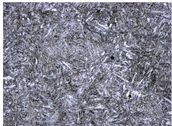
Obr. č. MZ 6 – ocel 34CrAlNi7- příčný řez - zvětšeno 500x
