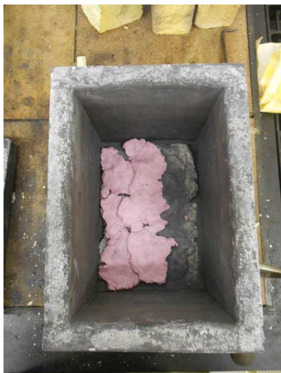
Obr. č. N2 - Krabice pro nitridaci - umístěn aktivátor růžové barvy a konzistence modelíny, na vrstvu nitridačního prášku
