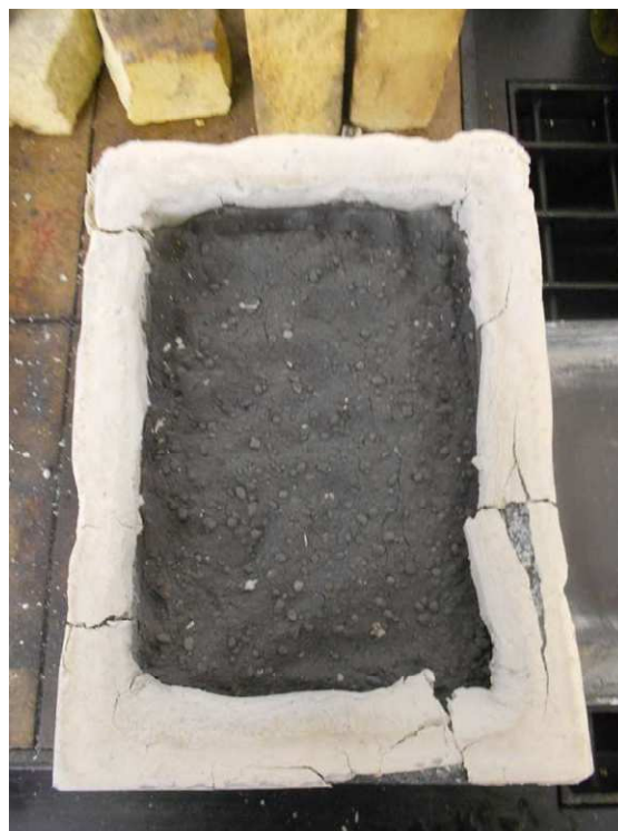
Obr. č. N8 - Krabice pro nitridaci – po vyjmutí z pece a sejmutí víka, po proběhnutí 7 nitridačních cyklů
