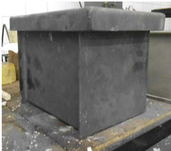
Obr. č. N5 - Krabice pro nitridaci – připravena pro umístění do pece
