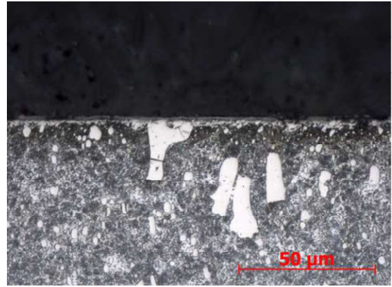
Obr. č. MN59 ocel Sverker 3- 520°C - 24 hodin, zvětšeno 500x
