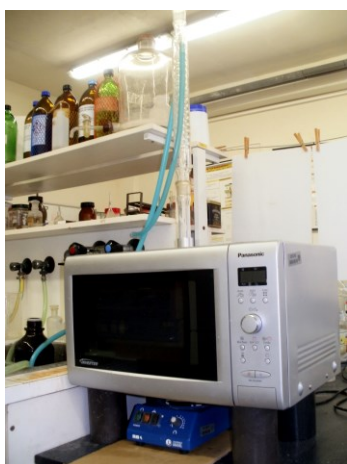
Obr. 6-28 Mikrovlnný reaktor PANASONIC s chladičem.
