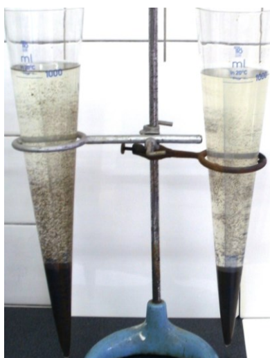
Obr. 6-33 Průběh sedimentace v Imhoffových válcích.
