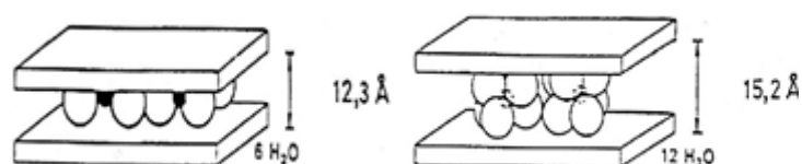
Obr. 3-21 Schématické uspořádání monovrstvy (vlevo) a dvou vrstev (vpravo) vody. Zdroj [17]
