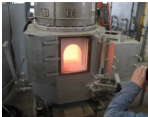
Obrázek 2-12 Mikrovlnná sklářská pec. Zdroj [4]
