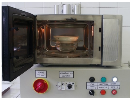
Obr. 5-23 Mikrovlnný reaktor MWG1k-10.
